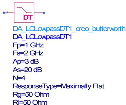
**Figura 3.16:** Representación en el ADS de un filtro paso bajo de Butterworth.
