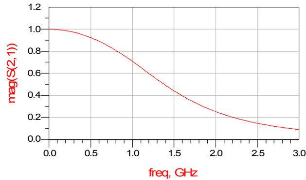
Figura 3.39: Respuesta de un filtro de Bessel-Thomson.
