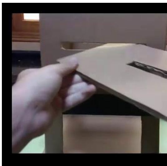
Figura A2.6: Se introduce el tablón de cartón en una de las caras del cuerpo de cartón.
