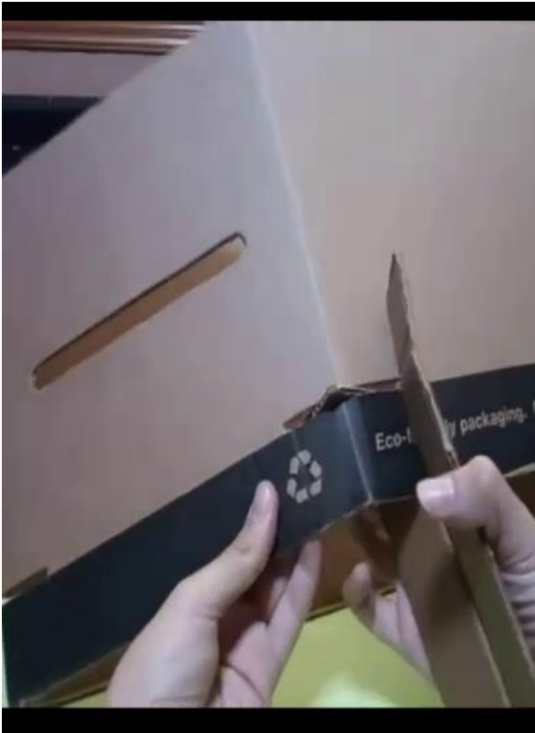
Figura A2.2: Se atraviesa el cuerpo de cartón con una de las pestañas de la pata de cartón.
