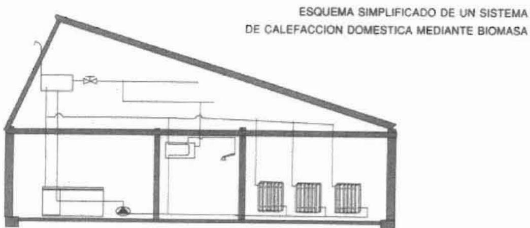
Su instalación suele ser muy sencilla y solamente se precisa la conexión a la salida de humos. Se construyen cocinas-estufas cerradas de hasta 20.000 Kcal/h., y se pueden esperar rendimientos en la combustión entre el 70 % y 80 %.
