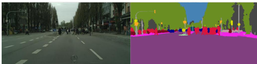
Figura 2.10: Ejemplo de imagen segmentada semánticamente. **Izq.** Imagen original. **Der.** Imagen segmentada.
