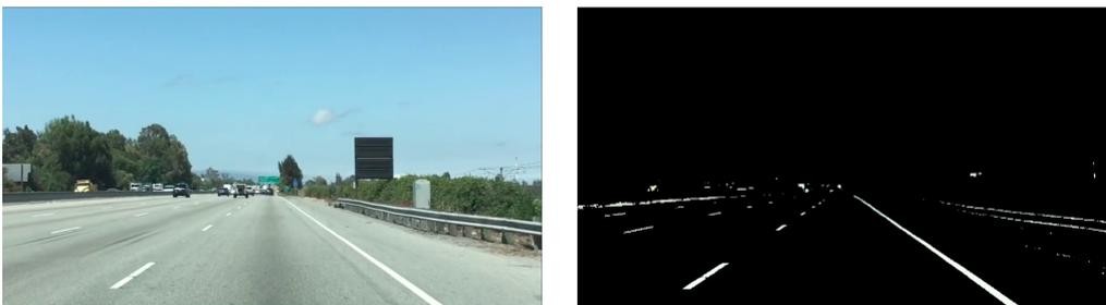
Figura 2.3: **Izq.:** Imagen de la carretera. **Der.:** Resultado tras filtrar la imagen por el color RGB [200, 200, 200].
