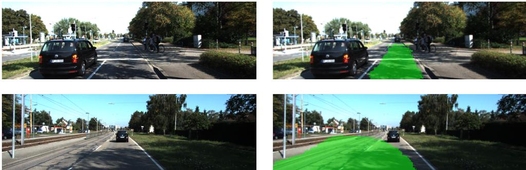
Figura 4.2: Resultados de la segmentación de la arquitectura 1. **Izq.:** Escena real. **Der.:** Segmentación de carretera realizada
