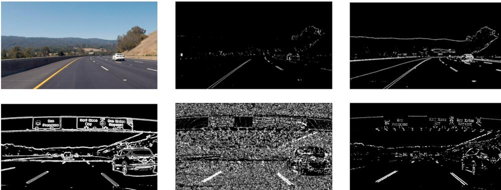
Figura 2.8: **a)** Imagen original. **b)** Bordes en eje x. **c)** Bordes en eje y. **d)** Bordes mediante cálculo de la magnitud del gradiente. **e)** Bordes mediante cálculo de la dirección del gradiente. **f)** Resultado final.
