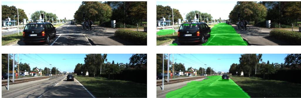
Figura 4.4: Resultados de la segmentación de la arquitectura 2. **Izq.:** Escena real. **Der.:** Segmentación de carretera realizada
