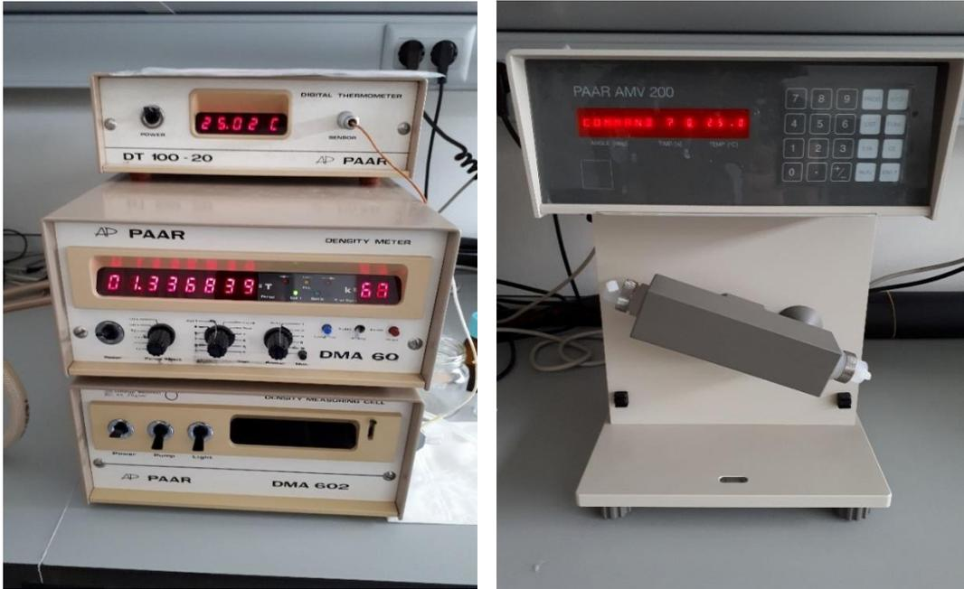
Fotografías 7.1 - 7.2 – Densímetro (izq.) y viscosímetro (dcha.)
