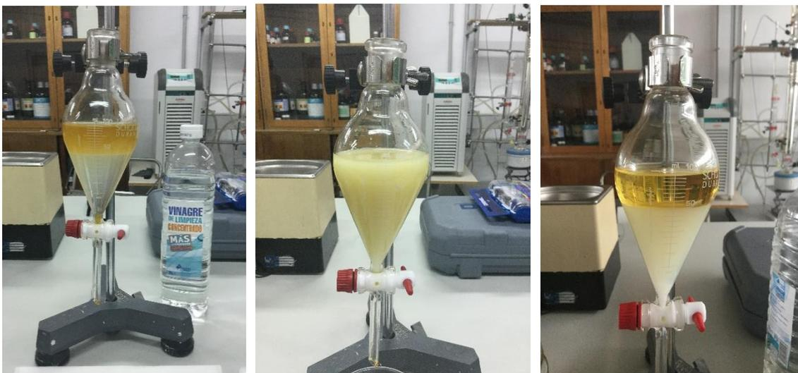
Fotografías 6.15 - 6.17 – Mezcla de biodiésel y fase acuosa antes de agitar (izq.), después de agitar (centro) y tras la emulsión (dcha.)
