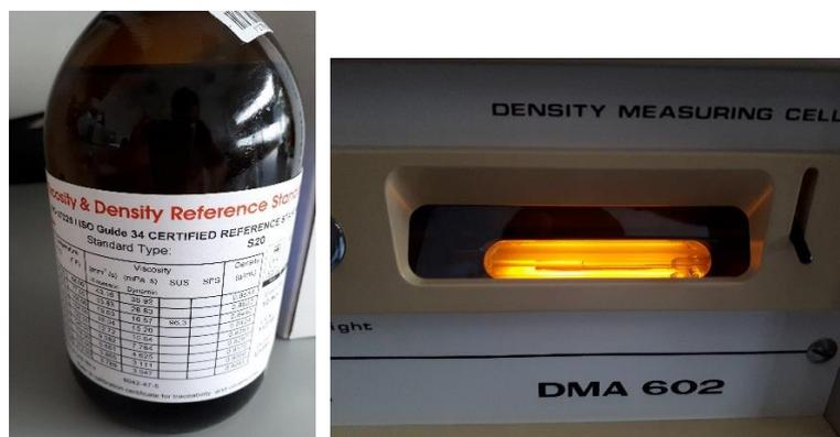
Fotografías 7.3 y 7.4 – Patrón S20 (izq.) y capilar del densímetro (dcha.)
