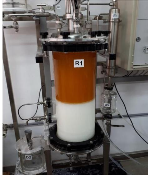
*Fotografía 6.29 (derecha) – Mezcla de agua, vinagre de limpieza y biodiésel “sucio” en el instante  $t = 24 \text{ horas}$*
