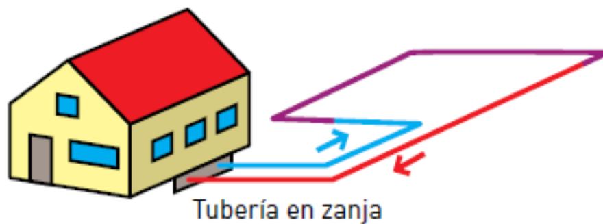
Ilustración 4. Sistema cerrado con intercambiador de calor horizontal de un bucle
