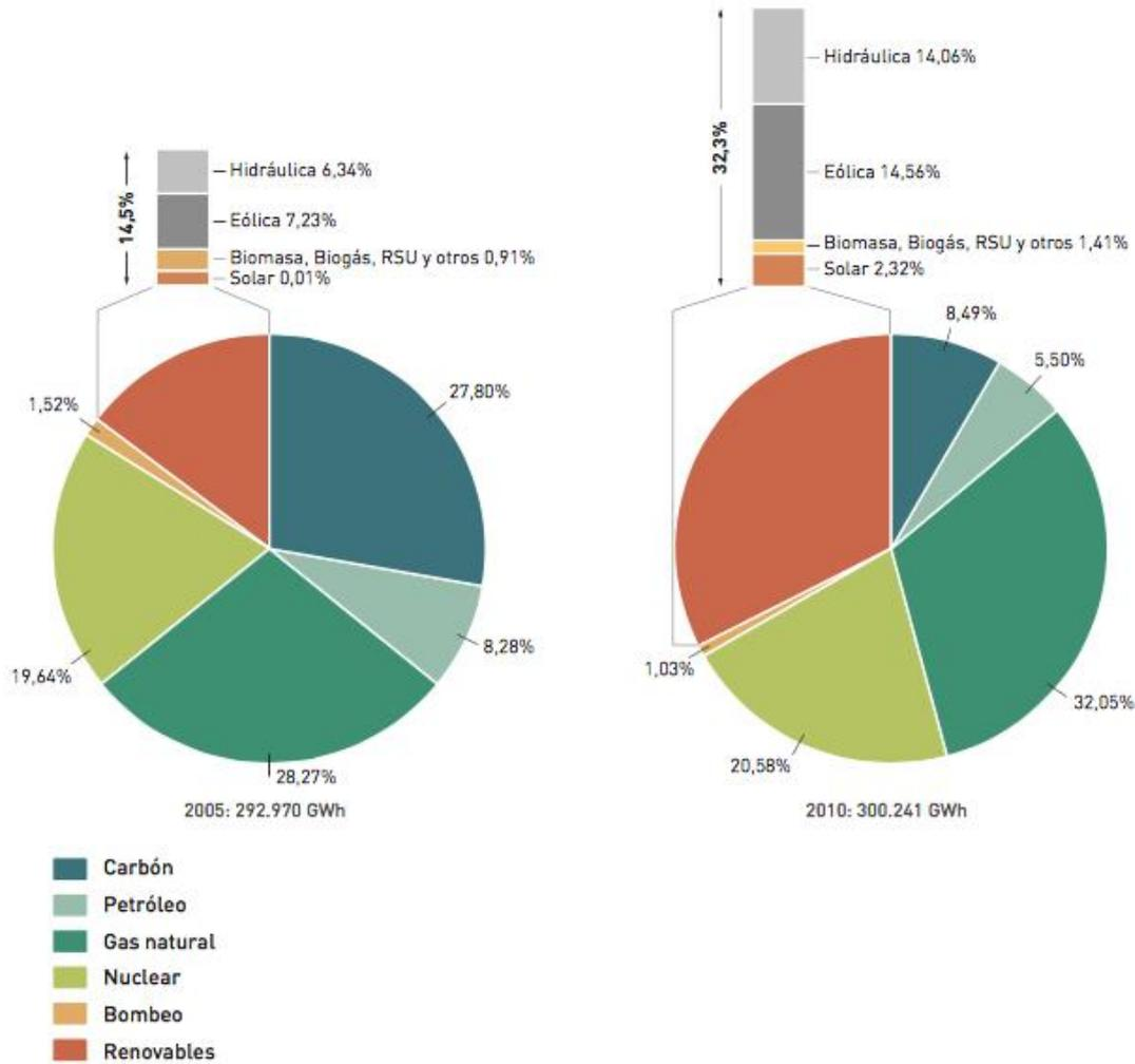
Figura 3.7 Estructura de Generación por fuentes energéticas en España. [Plan de Energías Renovables (PER) 2011-2020] IDAE 2011.
