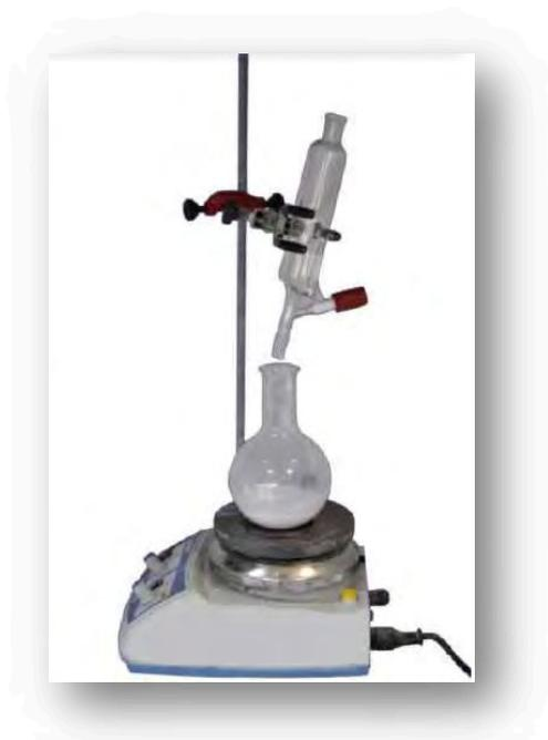
*Figura 3.3: Montaje para la síntesis del catalizador ECT (Portillo Carrizo, 2013).*
