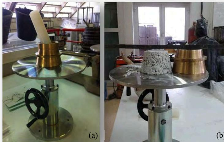
Figura 5.6: (a) Mesa de sacudidas utilizada y (b) Ejemplo de ensayo de consistencia para CEMI 52.5R blanco con 5% P25.
