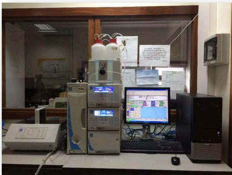
*Figura 3.9: Cromatógrafo iónico.*
