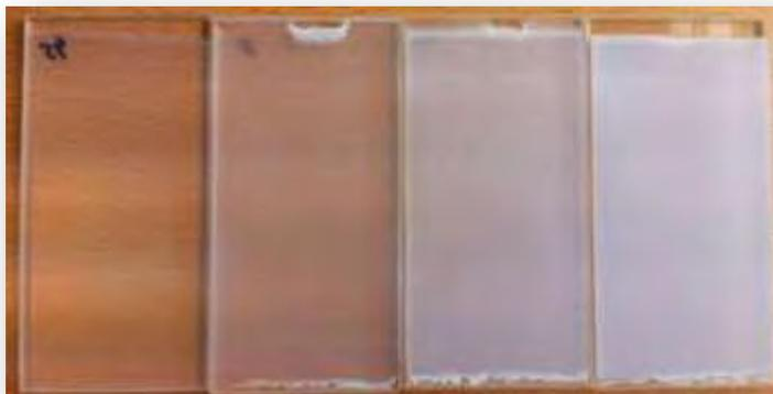
*Figura 3.16: Depósitos de P90 según la masa de fotocatalizador depositado: 0.24, 0.52, 1.16 y 1.68 mg·cm<sup>2</sup> (de izquierda a derecha).*
