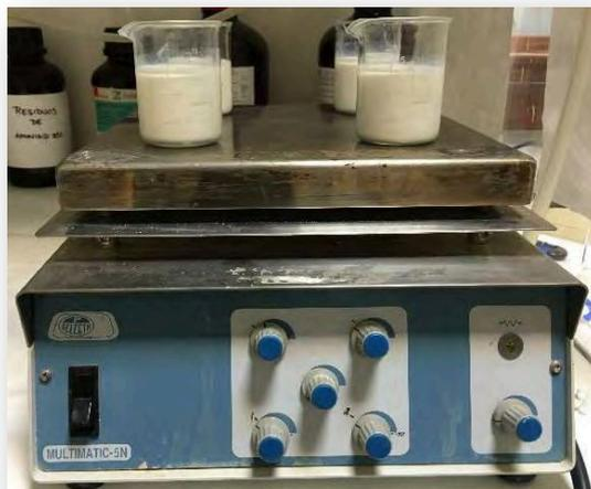
*Figura 4.2: Sistema para la reducción química del Pt.*
