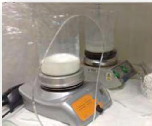
*Figura 4.4: Montaje para la impregnación del Fe.*
