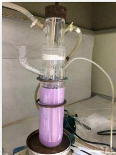
Figura 4.1: Montaje del sistema para la fotodeposición de Au.
