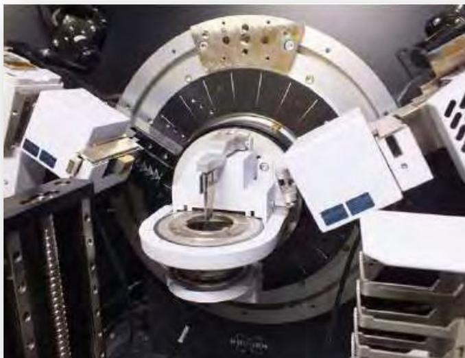
*Figura 3.11: Portamuestras del difractómetro Bruker D8 Advance.*
