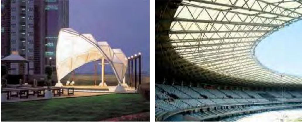
*Figura 1.15: Toldos y membrana fabricados en textil fotocatalítico.*
