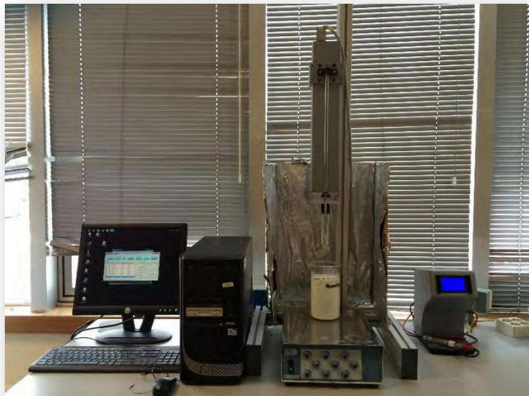
Figura 3.2: Dip-coater utilizado para la deposición de  $\text{TiO}_2$  en el soporte de vidrio.
