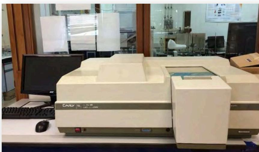
*Figura 3.13: Espectrofotómetro UV/Vis con esfera integradora.*
