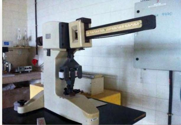
*Figura 5.8: Equipo de flexo-tracción utilizado.*
