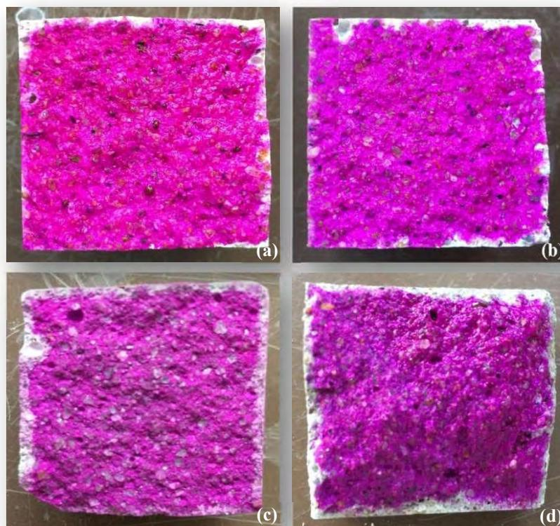
Figura 5.27: Carbonatación de morteros a 365 días: B (a), B-10 (b), G (c) y G-10 (d).
