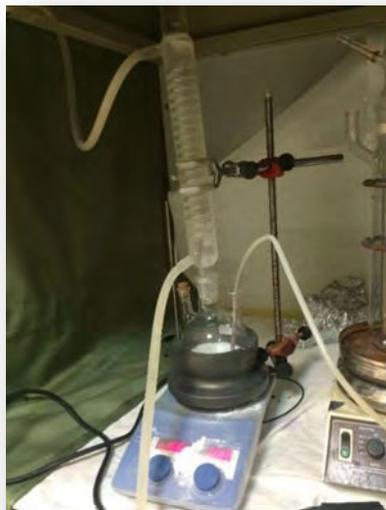
Figura 4.3: Montaje para la reducción química del Au.
