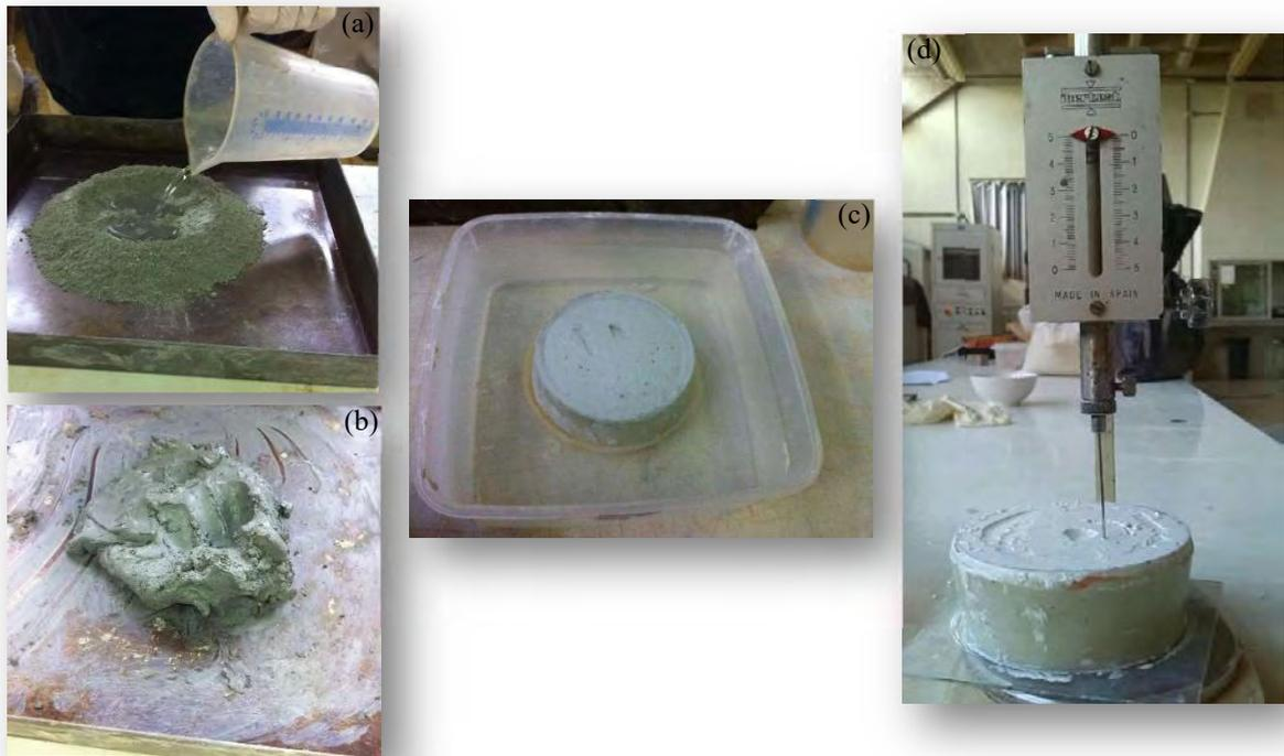
Figura 5.7: Esquema visual de la determinación del tiempo de fraguado: (a) Mezcla de cemento y agua, (b) Amasada de la mezcla, (c) Molde con cemento fresco a analizar, (d) Aparato de Vicat.
