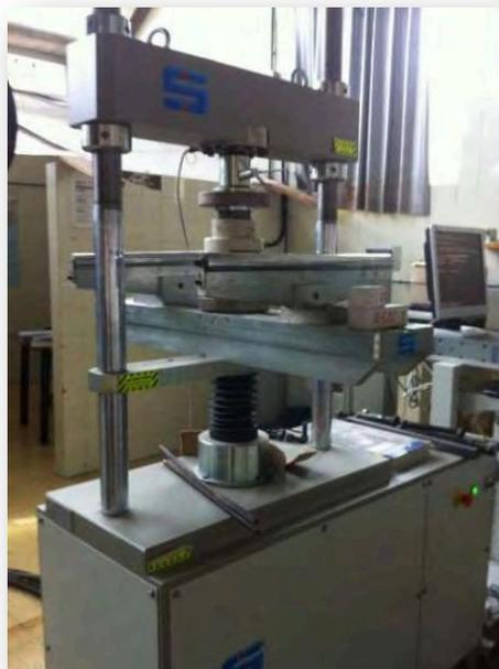
*Figura 5.9: Equipo de compresión empleado.*
