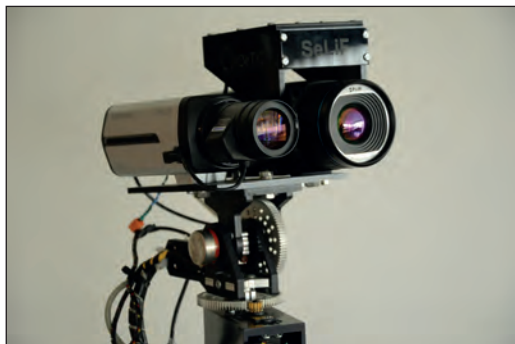
Fig. 5. Cámara visible y térmica sujetas a la base que mueven los servos.
