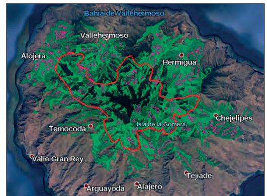
Fig. 12. Zonas cubiertas desde los puntos de observación, considerando 3Km de rango de detección. En color cian se han representado las zonas de sombra.
