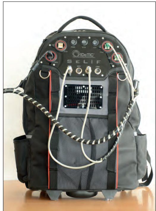
Fig. 6. Mochila adaptada que contiene los subsistemas de control, alimentación y comunicaciones.
