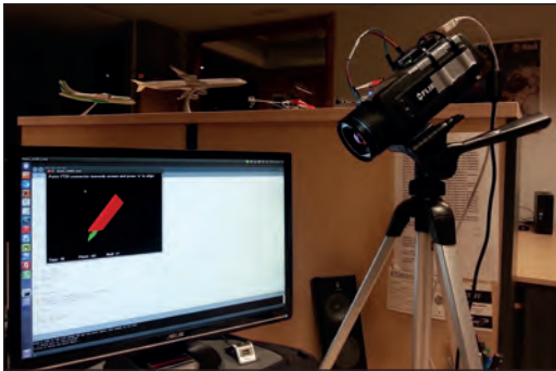
Fig. 3. Placa de evaluación del sistema de orientación Razor-9DOF en la cámara térmica usada en el sistema de autocalibración. Se ha superpuesto la nube de puntos que se obtiene en el proceso de calibración.
