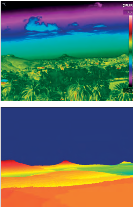
Fig. 1. Ejemplo de aplicación para imagen térmica e imagen sintética elaborada para el proyecto SeLiF. Al fondo y centrada, puede observarse la Montaña de Arucas. a) Imagen obtenida con cámara térmica (640x480 puntos). b) Representación de alturas asociadas a cada punto de la imagen sintética (640x480 puntos).
