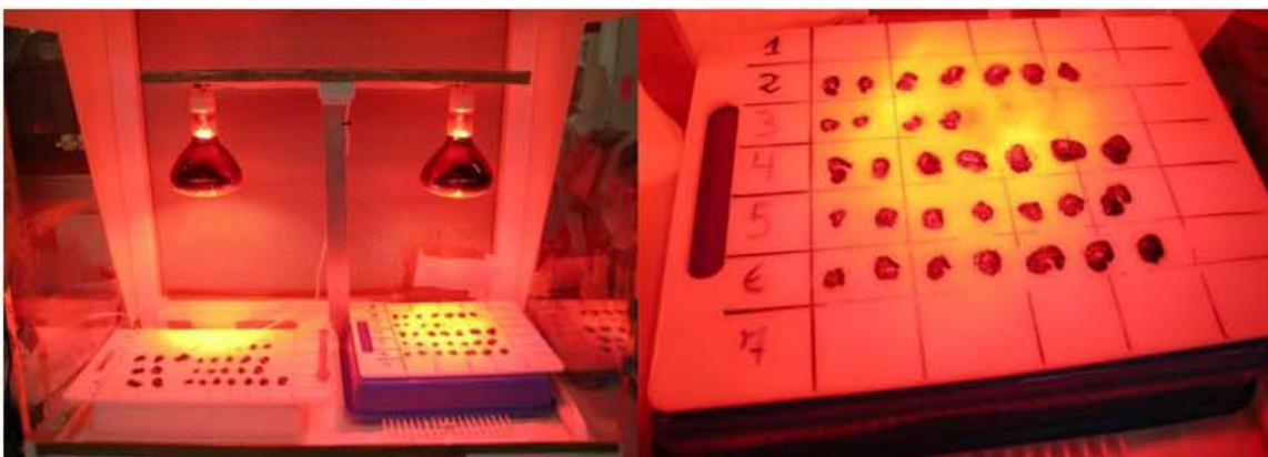
**Figura 2.** Proceso de secado bajo lámparas de luz IR.
