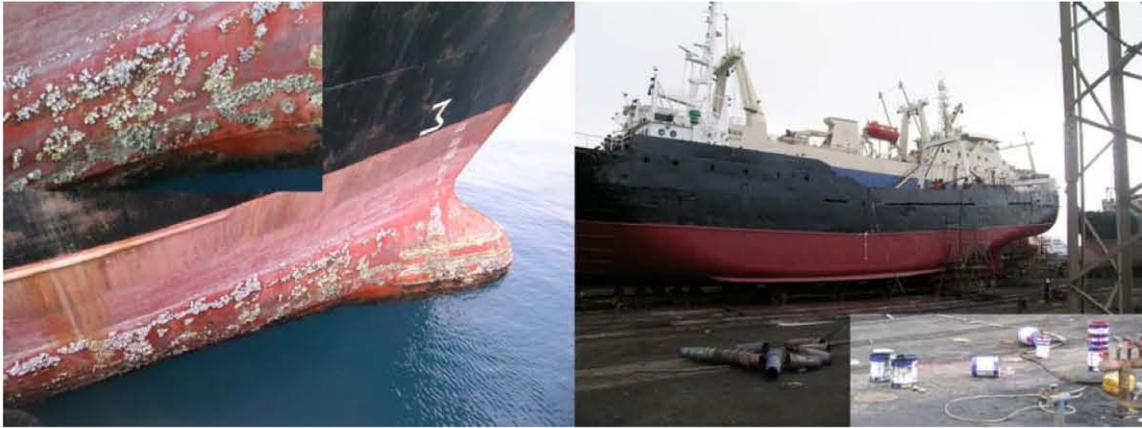
**Figura 1.** El crecimiento del *fouling*, es decir, material biológico indeseado tales como algas y sacabocacos, reducen la navegabilidad de los barcos (fotografía de la izq.). El uso de pinturas anti-incrustantes, en cambio, prolonga la conservación y facilitan el movimiento de los mismos (fotografía de la dcha.).
