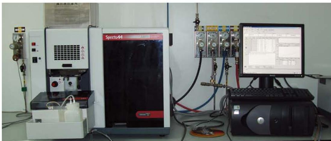
**Figura 4.** Espectrofotómetro de absorción atómica de llama.
