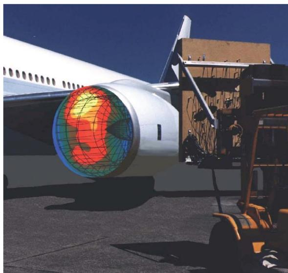
**Figura 1.9** Índice de ruido en la turbina de un avión.
