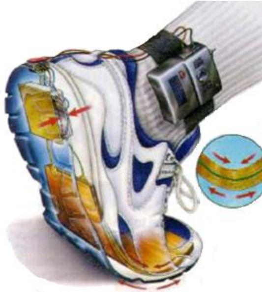
**Figura 1.4** Material piezoeléctricos colocado en el calzado.
