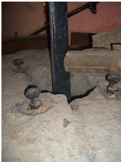
Detalle de piedra superior. Molino de viento en TM La Aldea. Gran Canaria.
