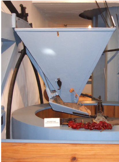
Detalle de la tolva anclada al muro del edificio del molino de viento en TM de Breña Alta. La Palma.
