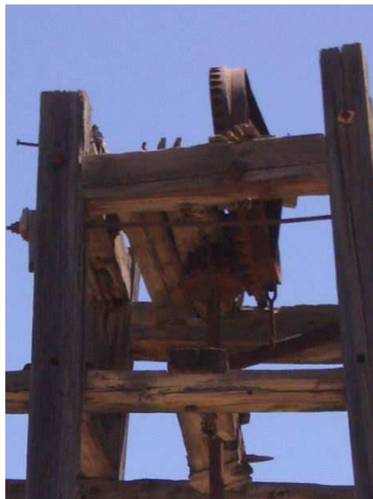
Detalle de enlace de la rueda catalina y el piñón de transmisión o linterna del molino de viento "Sistema Romero" en Artejevez. TM de La Aldea de San Nicolás. Gran Canaria.
