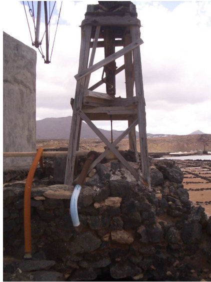
Detalle del vástago metálico y tubo de descarga del molino de viento "Salinero Canario" en salinas del Janubio, TM de Yaiza. Lanzarote.
