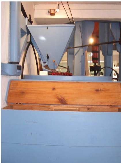
Detalle de cofre o caja que sirve para almacenar el gofio o harina procedente de las muelas o piedras de molturación del Molino de viento de El Lodero. TM de La Villa de Mazo. La Palma.
