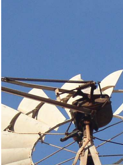
Detalle del resorte que regula la cabeza del rotor y la cola de orientación del molino de viento Aeromotor "Tipo Americano" en TM de La Aldea, Gran Canaria.
