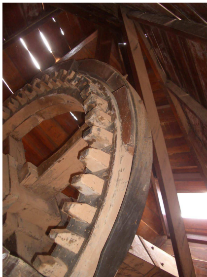
Detalle del freno de madera de la rueda catalina. Molino de viento en TM La Antigua. Fuerteventura.
