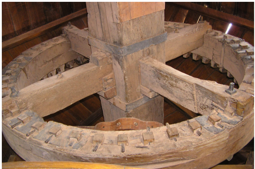
Rueda catalina del molino de viento de TM La Antigua. Fuerteventura.
