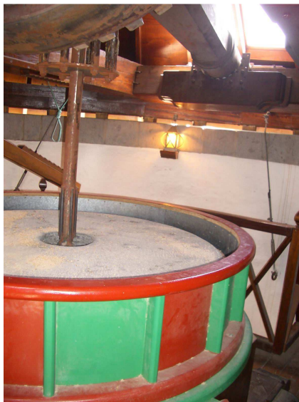
Detalle de enlace de la rueda catalina y del resto de la maquinaria de molienda. Molino de viento en TM de Mogán. Gran Canaria.
