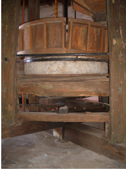
Detalle de la caja, el guardapolvos y piedras molederas del molino de viento "Sistema Romero" en Carrizal. TM de Ingenio. Gran Canaria.
