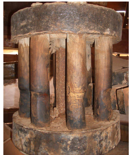
Detalle del husillo del molino de viento en Tiscamanita, Fuerteventura.
