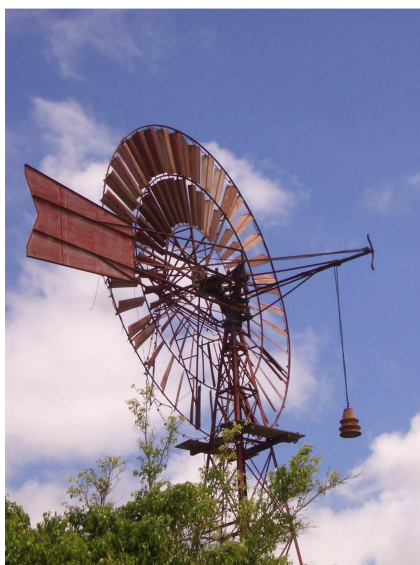
Detalle del rotor multipala de aspas, del sistema de orientación y del sistema de regulación (contrapeso) del molino de viento aeromotor del modelo "Manuel Santana" en TM de Ingenio. Gran Canaria.
