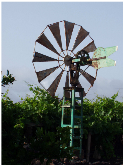
Detalle de la torre metálica y el rotor de doce aspas metálicas del molino aeromotor producto de la inventiva popular en talleres artesanales en Puerto del Carmen. Lanzarote.
