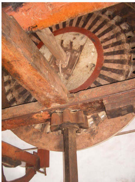
Detalle de la rueda catalina y del piñón del molino de viento harinero "Tipo Torre" de Los Majanos, TM La Aldea de San Nicolás. Gran Canaria.
