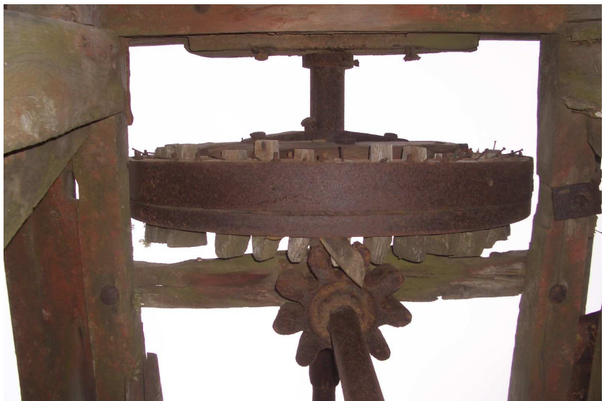
Detalle de la Rueda Catalina o capacete. Villa de Mazo, La Palma.
