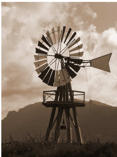
Molino de viento "aeromotor del País" destinado para bombear agua. Lanzarote.
