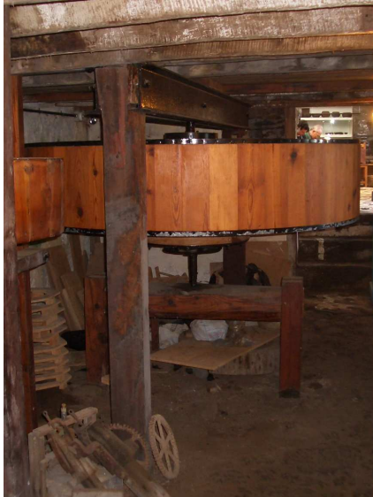
Detalle del tambor situado bajo la torre cuadrada de madera. En esta situación los dos tambores se unen mediante una correa de cuero de 20 cm. de espesor. Molino de viento en El Loder. TM de La Villa de Mazo. La Palma.
