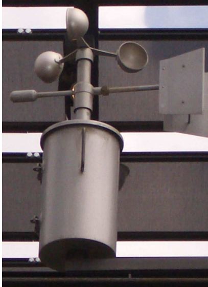
Detalle anemómetro de cazoletas.
