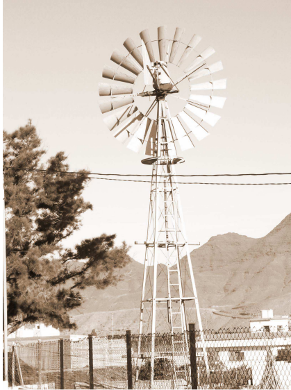
Molino de viento "aeromotor" de rotor multipala de chapa y destinado al bombeo de agua. TM La Aldea de San Nicolás, Gran Canaria.
