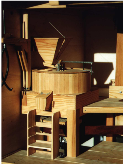
Detalle de caja y el guardapolvos. Maqueta del Molino de viento de Las Tricias. TM de Garafía La Palma.
