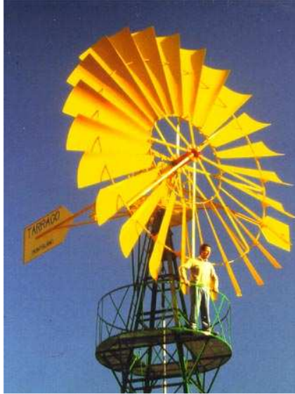
Detalle del rotor multipala de aspas de chapas metálicas de siete metros de diámetro sobre torre piramidal metálica del molino de viento aeromotor español modelo Tarragó.
