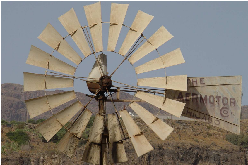
Detalle del rotor multipala de chapa del Aeromotor "Tipo Americano"
