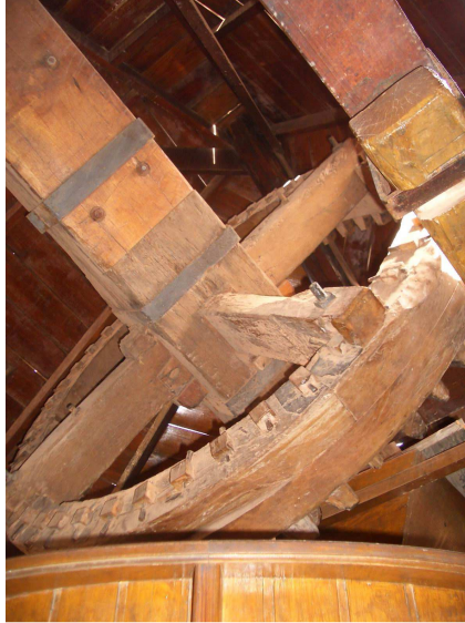
Detalle de la rueda catalina. Molino de viento en TM de La Antigua. Fuerteventura.
