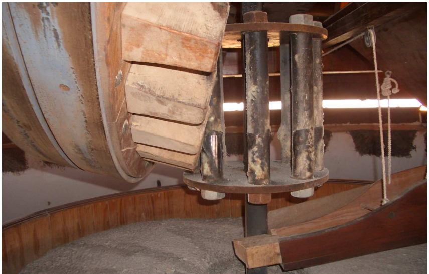
Detalle del husillo del molino de viento en Tiscamanita, Fuerteventura.
