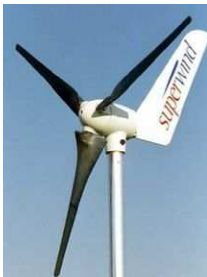
Detalle del aerogenerador de baja potencia de rotor de tres palas y torre tubular de acero de la marca comercial superwind.
