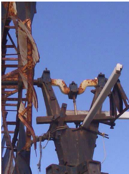
Detalle del sistema de transmisión biela-cigüeñal del molino de viento Aeromotor de rotor multipala "Tipo Americano" situado sobre una torre con forma piramidal triangulada construida de madera en TM de Tegüise. Lanzarote.
