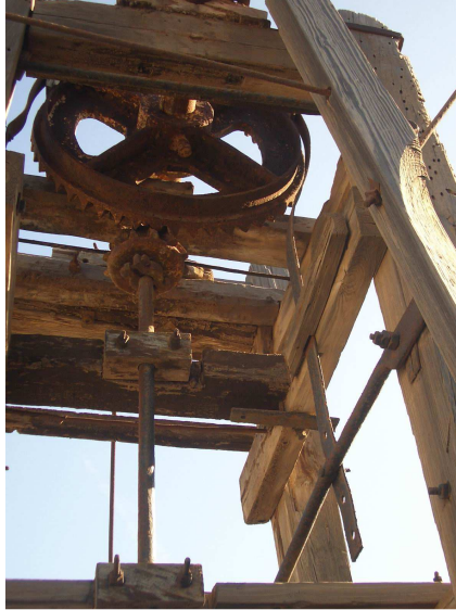
Detalle del freno sobre la rueda catalina del molino de viento "Sistema Romero" en Carrizal. TM de Ingenio. Gran Canaria.
