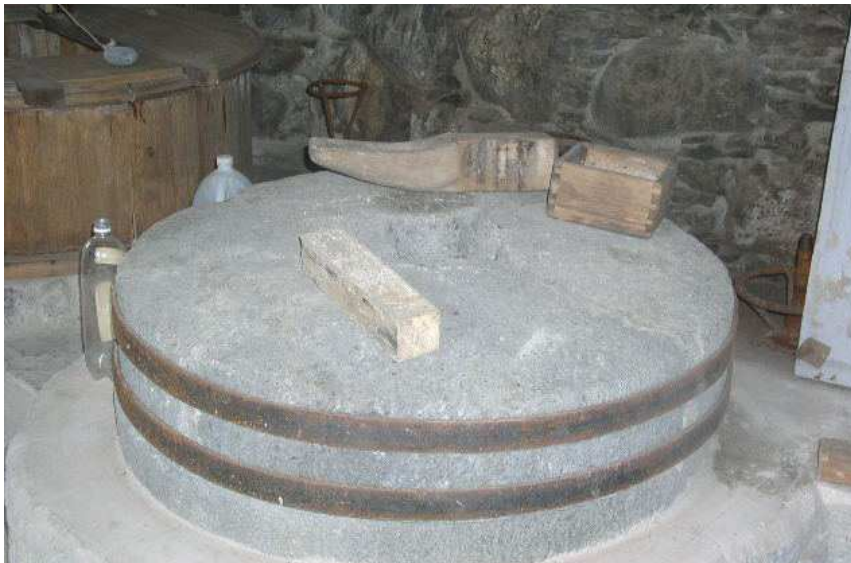
Detalle de abrazaderas de hierro en piedras molidoras del molino.
