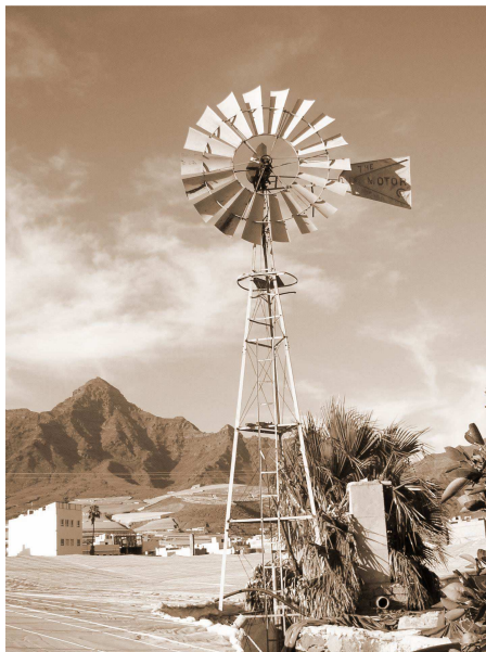
Detalle del molino de viento aeromotor de "Tipo Americano" destinado para bombear agua. TM La Aldea de San Nicolás. Gran Canaria.
