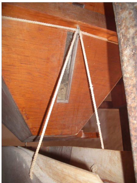
Detalle del cristal transparente incrustado en la tolva de la molina de viento en Tefía, TM de Puerto del Rosario. Fuerteventura.
