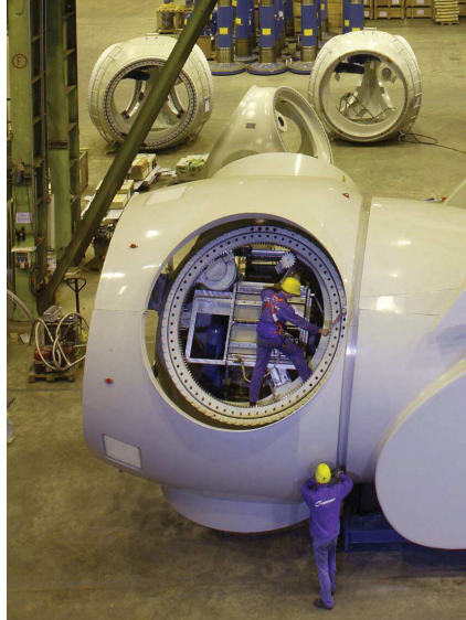
Detalle del cubo del aerogenerador de tres palas de la marca Nordex.
