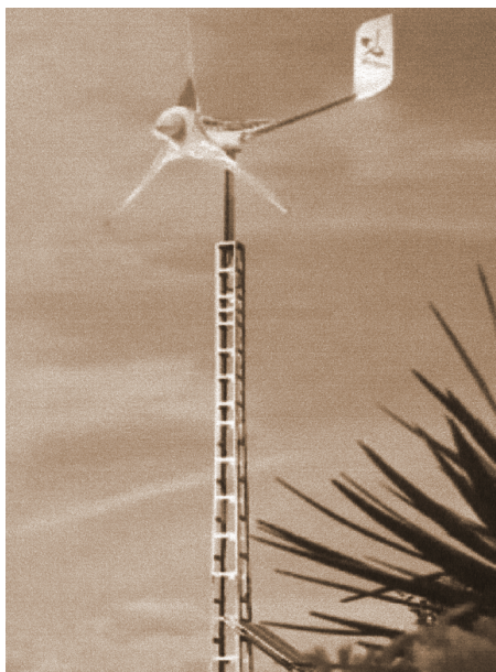
Molino tipo aerogenerador de baja potencia de torre en celosía de estructura metálica y rotor de tres palas. En la etapa tecnológica de las turbinas eólicas se producen una gran evolución técnica, utilizándose nuevos materiales más ligeros y resistentes a la vez que se introducen sistemas eléctricos de regulación y de control.
