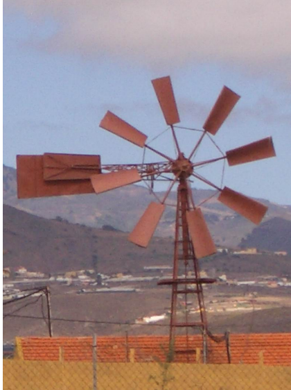
Detalle de la torre piramidal metálica y el rotor de ocho aspas metálicas del molino de viento aeromotor de la marca comercial alemana Alder, en TM Telde. Gran Canaria.
