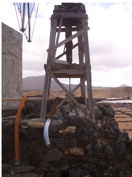
Detalle del tubo de descarga del agua de mar procedente de la bomba hacia los cocederos y los tajos de las salinas. Molino de viento "Salinero Canario" en las salinas del Janubio, TM de Yaiza. Lanzarote.
