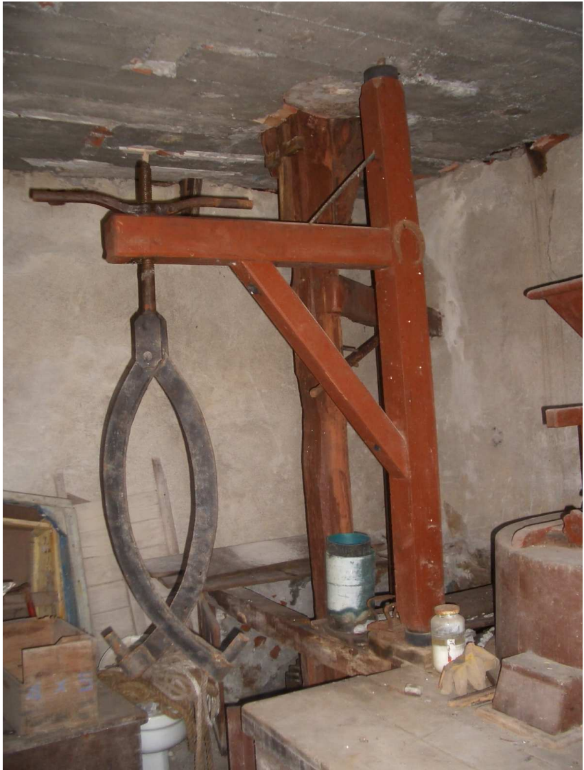
Detalle del pescante pivotante destinado a la retirada de las piedras molederas para el picado o rayado geométrico. Molino de viento en TM de Breña Alta. La Palma.
