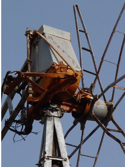
Detalle del cárter y de la coraza que protege los engranajes del sistema de transmisión del molino de viento Aeromotor "Tipo Americano" en TM de La Aldea, Gran Canaria.
