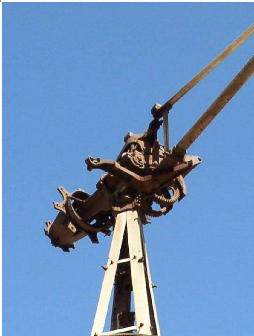
Detalle del cárter y de la coraza que protege los engranajes del sistema de transmisión del molino de viento Aeromotor "Tipo Americano" en TM de La Aldea, Gran Canaria.
