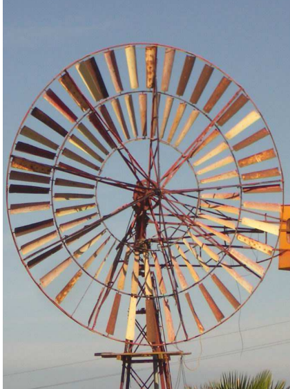
Detalle del rotor multipala de aspas de chapas metálicas del molino de viento del modelo "Manuel Santana" en TM de Ingenio. Gran Canaria.
