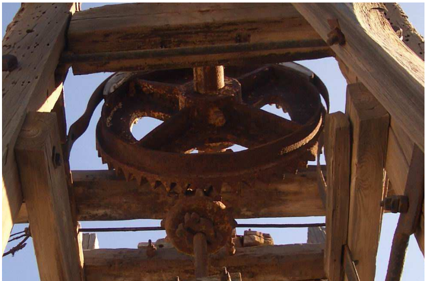
Detalle de la rueda catalina y de linterna de hierro de fundición del molino de viento "Sistema Romero" en Carrizal. TM de Ingenio. Gran Canaria
