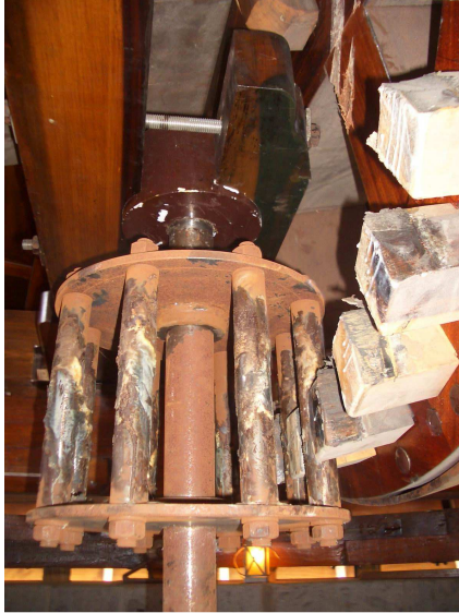
Detalle de enlace de la rueda catalina y el husillo o carrete. Los pivotes del husillo son de hierro. Molino de viento en TM de Mogán. Gran Canaria.
