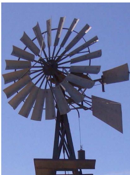
Detalle de la paleta situada en la dirección del rotor del molino de viento Aeromotor "Tipo Americano" en TM de Ingenio, Gran Canaria.
