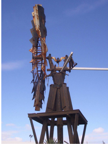
Detalle del sistema de transmisión biela-cigüeñal del molino de viento aeromotor del País de construcción artesanal en TM Tegüise. Lanzarote.
