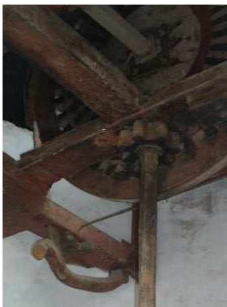
Detalle del freno sobre la rueda catalina del molino de viento "Tipo Torre" de Los Majanos, TM La Aldea de San Nicolás. Gran Canaria.
