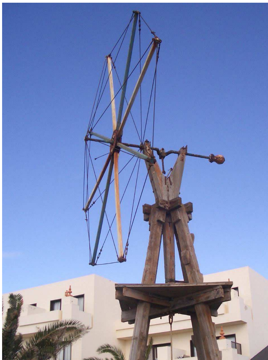
Detalle del sistema de transmisión Biela-Manivela y de la estructura soporte de la transmisión del molino de viento "Salinero Canario". Costa Teguise. Lanzarote.
