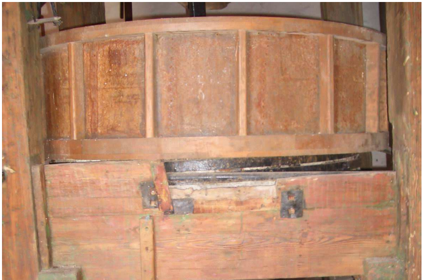
Detalle de la caja y el guardapolvos. TM de Ingenio. Gran Canaria.
