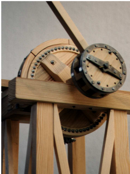
Detalle del buje ó la caja de aspas. Maqueta del molino de viento en Las Tricias. TM de Garafía. La Palma.
