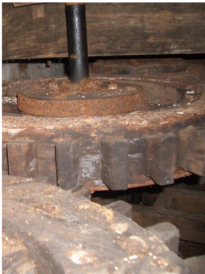
Detalle de la gran rueda dentada situado bajo la torre cuadrada de madera. En esta situación las dos ruedas dentadas se engranan entre sí. Molino de viento en TM de Breña Alta. La Palma.
