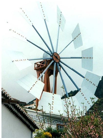
Detalle de la torre y el rotor de doce aspas del molino de viento "Sistema Ortega" en TM Villa de Mazo. La Palma.
