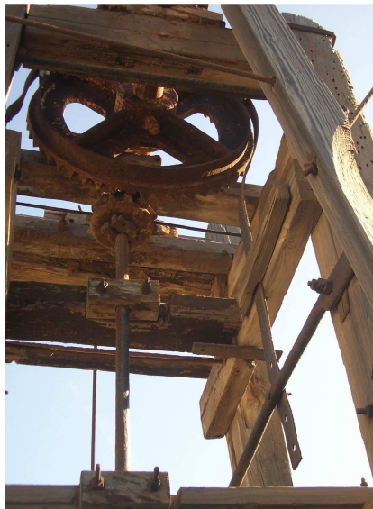
Detalle de la rueda catalina y de linterna de hierro de fundición del molino de viento "Sistema Romero" en Carrizal. TM de Ingenio. Gran Canaria
