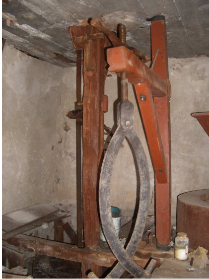
Detalle del pescante pivotante destinado a la retirada de las piedras molederas para el picado o rayado geométrico. Molino de viento en TM de Breña Alta. La Palma.
