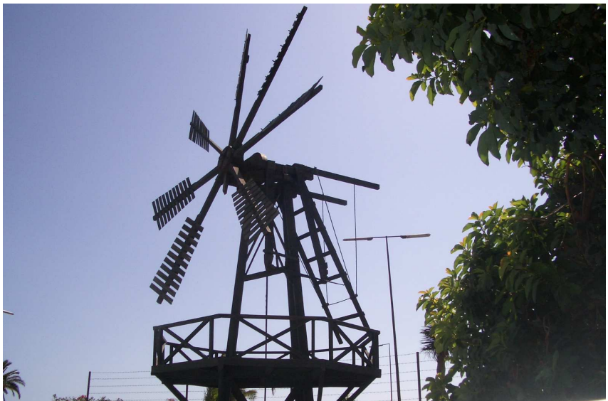
Este aeromotor de propia inventiva destinado al bombeo de agua situado en S/C de La Palma, incorpora detalles constructivos del molino harinero "Sistema Ortega" y de los molinos "Salineros Canarios".
