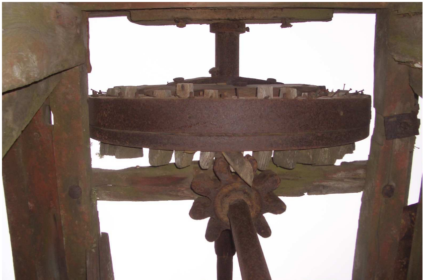
Detalle de enlace de piñón y capacete. Molino de viento en La Palma.
