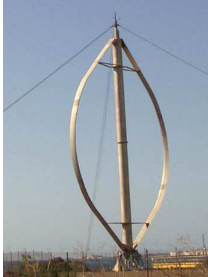
Detalle del aerogenerador de eje vertical tipo Darrieus, en Arinaga. TM Agüimes, Gran Canaria.
