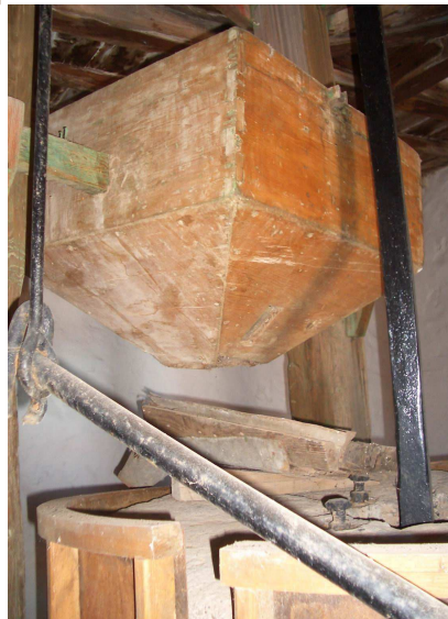
Detalle de la tolva del molino de viento "Sistema Romero" en Carrizal. TM de Ingenio. Gran Canaria.
