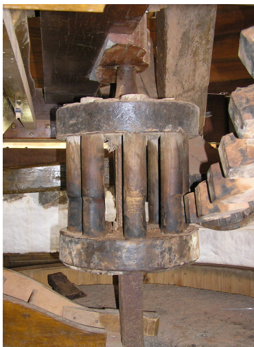
Detalle del husillo del molino de viento en Tiscamanita, Fuerteventura.
