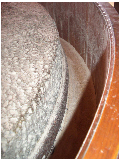
Detalle de la abrazadera de hierro que une los diferentes fragmentos de la piedra superior y móvil de la molina en Tefía, TM de Puerto del Rosario, Fuerteventura.
