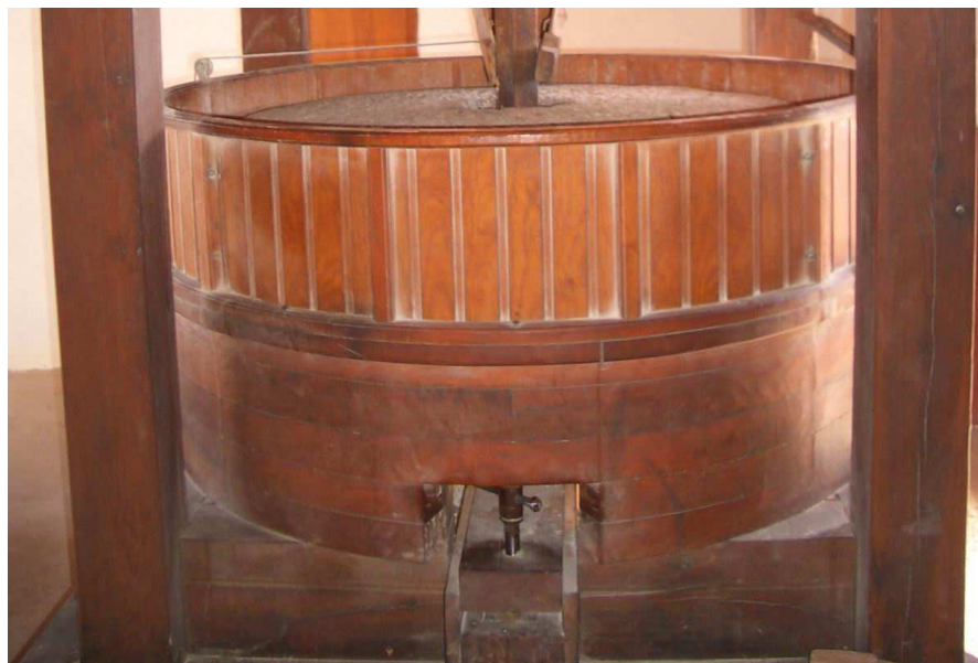
Detalle de la caja y el guardapolvos de la molina. Tefía. Fuerteventura.
