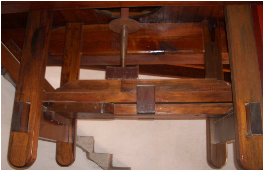
Enlace entre el aliviadero y el sopuente. Molino en Mogán. Gran Canaria.
