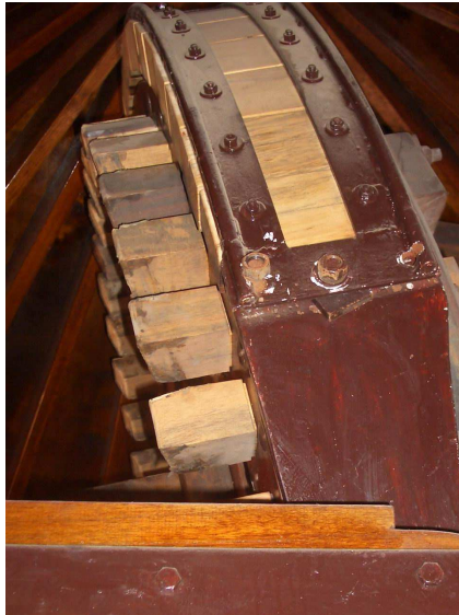
Detalle de freno sobre la rueda catalina o rueda dentada. Molino de viento en TM de Mogán. Gran Canaria.
