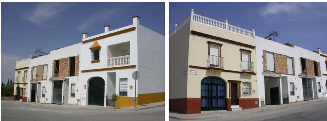
En esta imagen se aprecia la última fase del proceso de transformación en la promoción de Olvera, Cádiz (CA-19). Se crean dos ventanas verticales a partir del hueco horizontal inicial y se procede a la definitiva transformación: enmarcado de huecos, balcones y ventanas de rejas, arco rebajado, balaustres, pintura en zócalos y división de niveles, etc.
