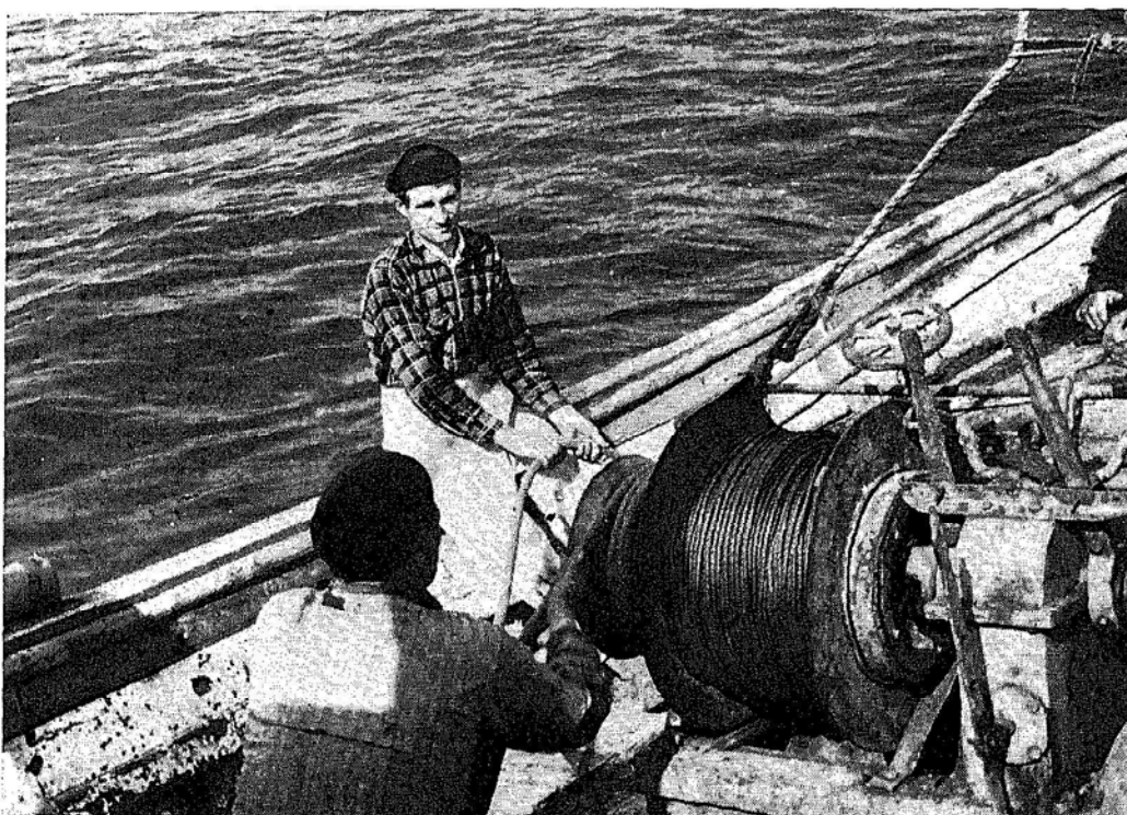
Foto 3.—Detalle de la operación de «cobrar» las malletas para halar el arte a bordo.
