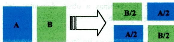
Figura 6.5. Esquema de dimensionar y emplazar dos condensadores en centroide común
