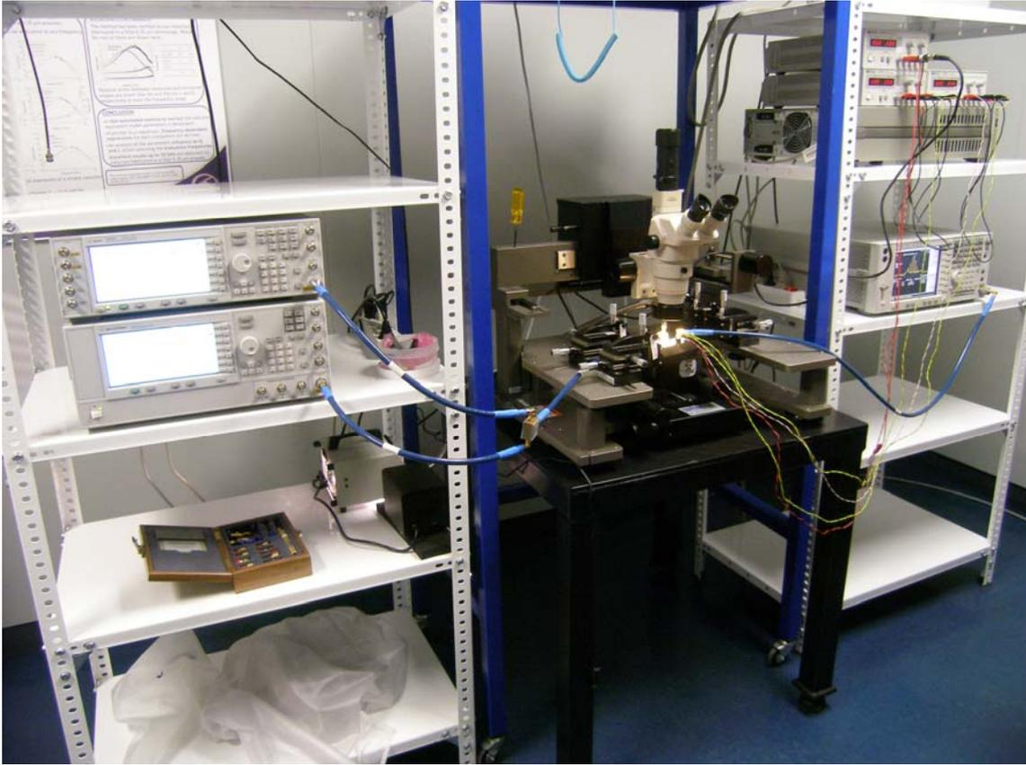
Figura A.10 *Set-up* de medida del IIP3.
