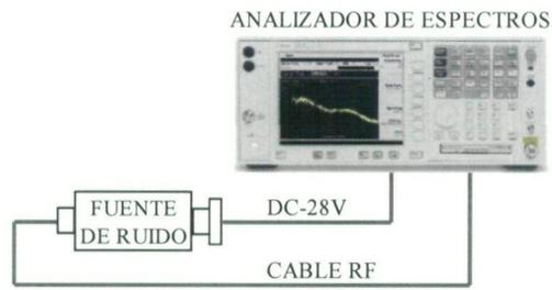
Figura 7.8: Calibración del ruido.
