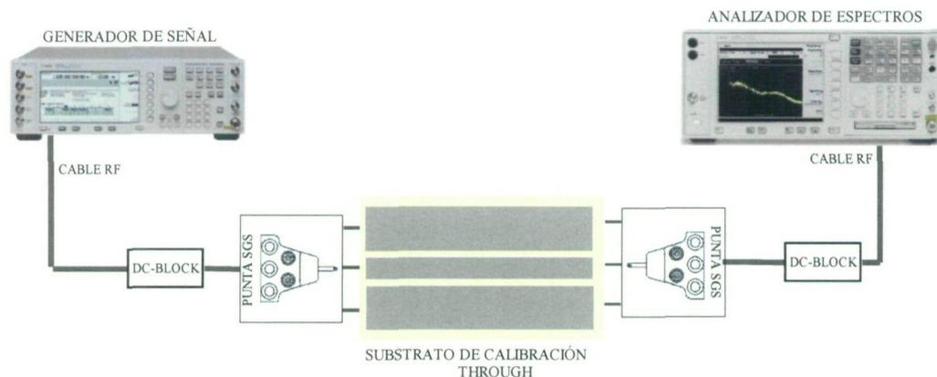
Figura 7.1: Circuito equivalente de medida para RF.
