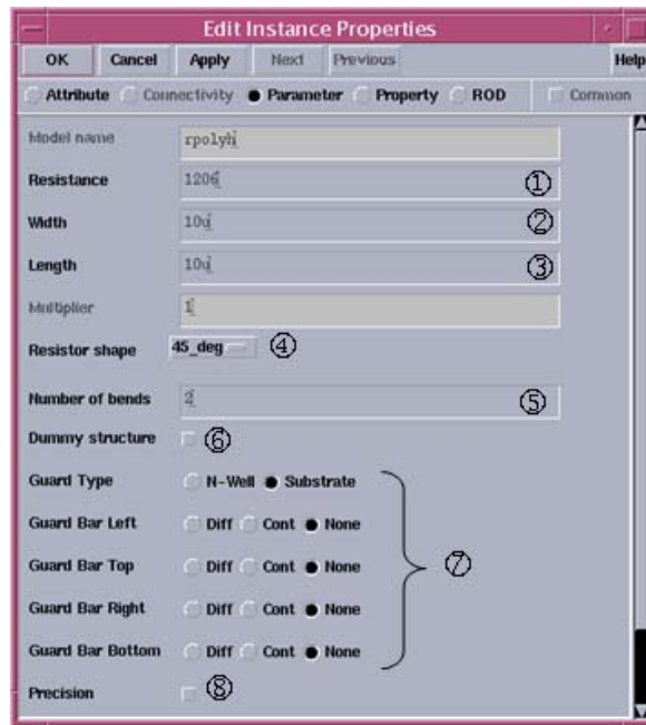
Figura 4.2 Parámetros en las resistencias.
