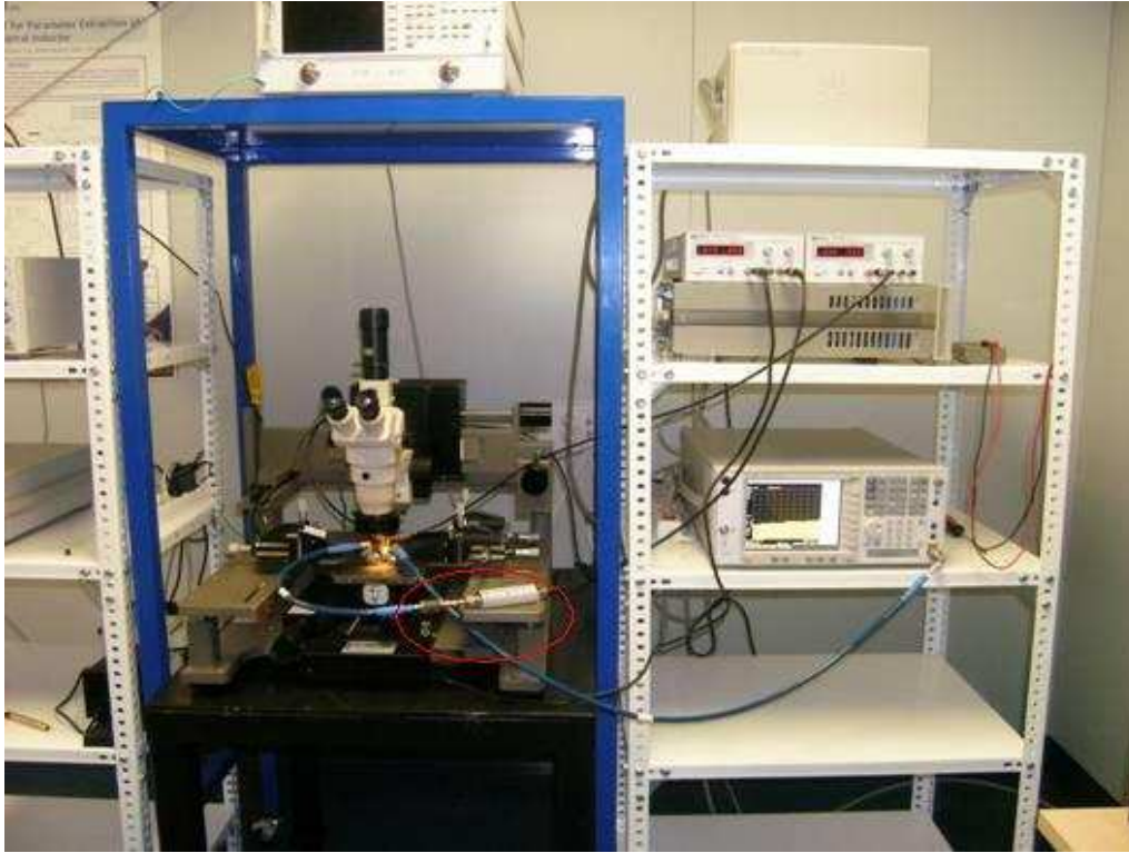
Figura 7.12 Equipo del laboratorio preparado para hacer la medida de la figura de ruido.
