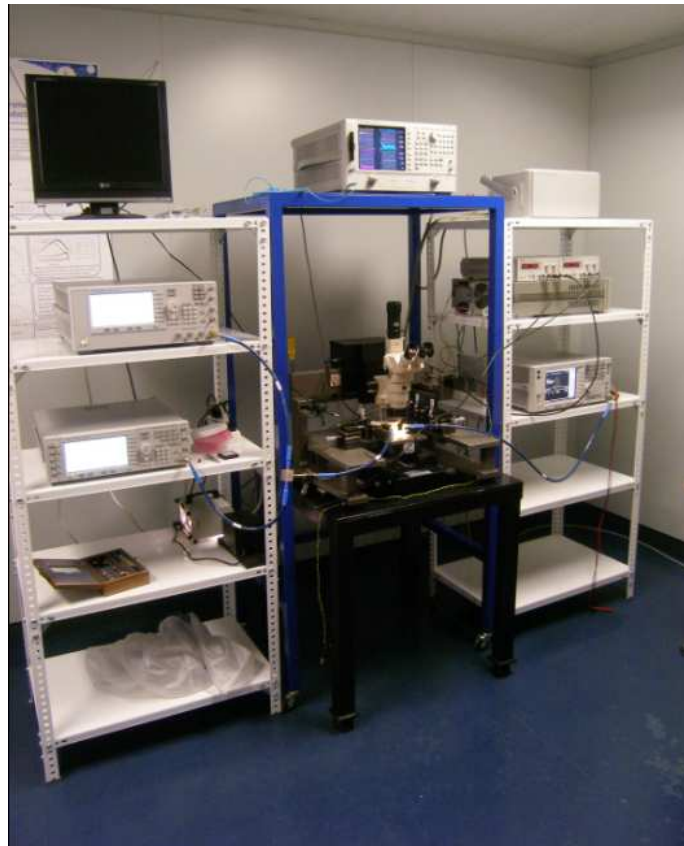
Figura 7.19 Equipo del laboratorio preparado para hacer la medida de la linealidad.
