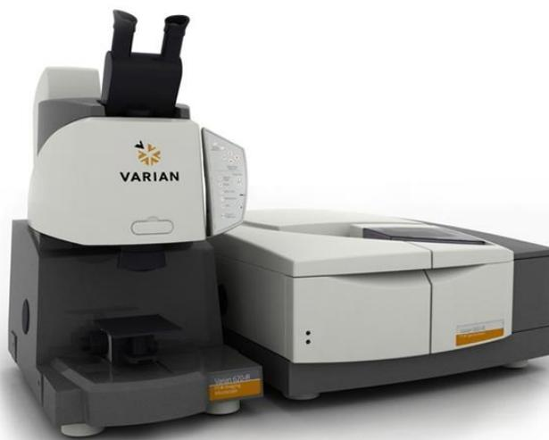
Figura 4.1: Espectrómetro Varian FT-IR 600 [108].
