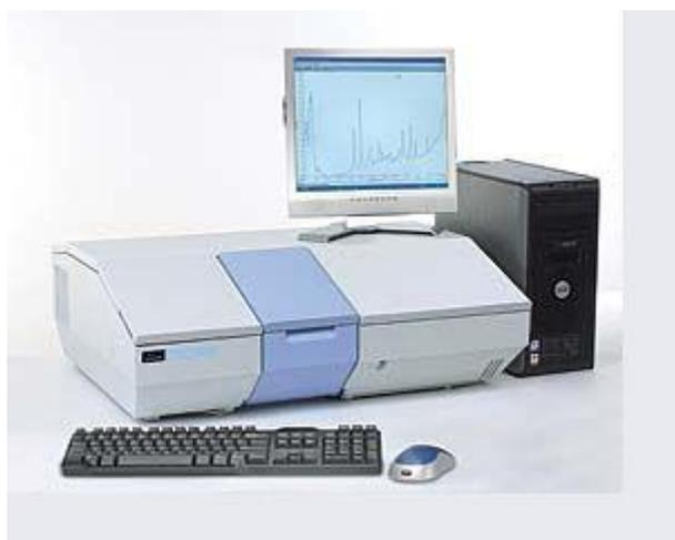
Figura 4.15: Espectrómetro PerkinElmer FT-IR System, Spectrum BX.
