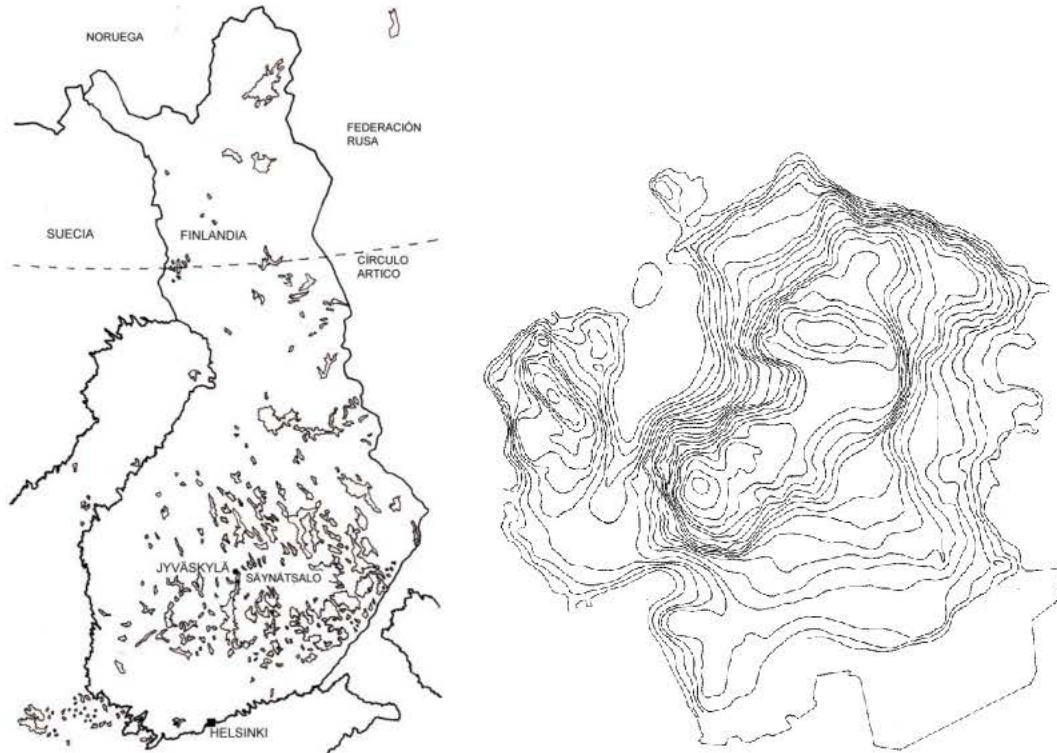
35. Izquierda, situación de Säuynätsälo en la región de Finlandia Central. Derecha, topografía. La isla principal, Säuynätsälo, tiene una superficie de 1,4 kilómetros cuadrados y una altura máxima de 38,70 metros sobre el nivel del lago. Dibujos del doctorando.
