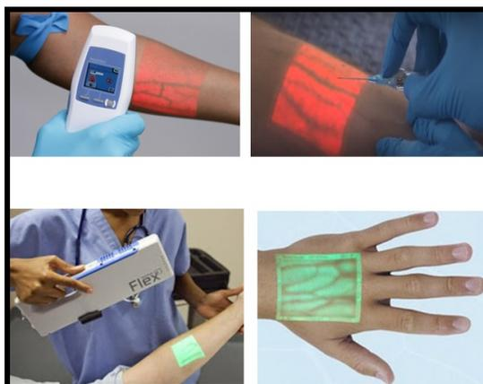
**Figura 4:** Dispositivo infrarrojo para facilitar la visión de las venas periféricas AccuVein® (arriba) y Vein Viewer Flex® (abajo).
