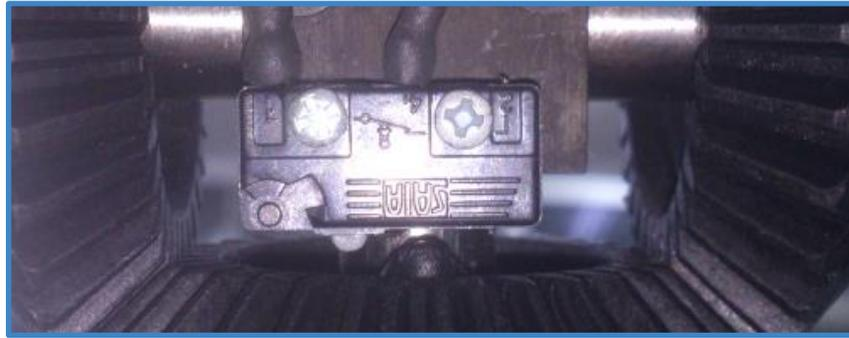
FOTO 5 - MICRINTERRUPTOR CORRESPONDIENTE AL ROLL DE LA PINZA.
