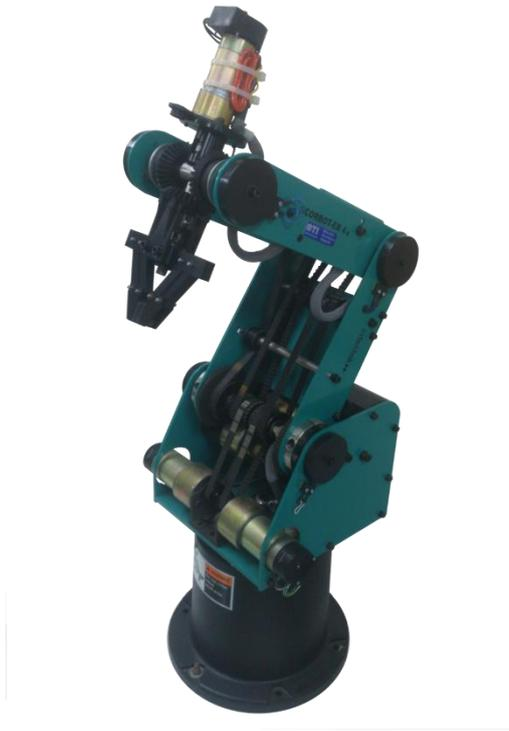
FIGURA 3 - BRAZO ROBOT DEL SCORBOT-ER 4U
