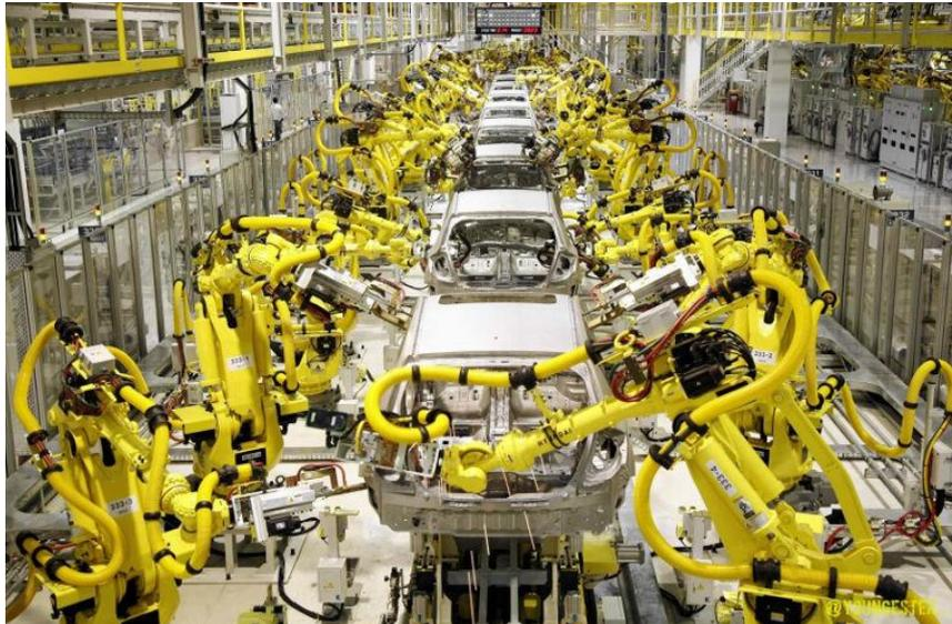
FIGURA 5 - FÁBRICA DE VEHÍCULOS DONDE LAS SOLDADURAS SON REALIZADAS POR BRAZOS ROBÓTICOS.
