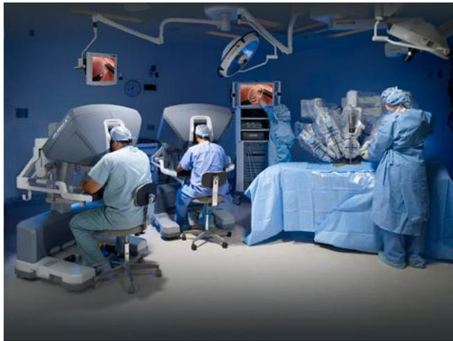
FIGURA 6 - DOS CIRUJANOS UTILIZAN TERMINALES PARA TRABAJAR JUNTOS CON EL ROBOT DA VINCI.
