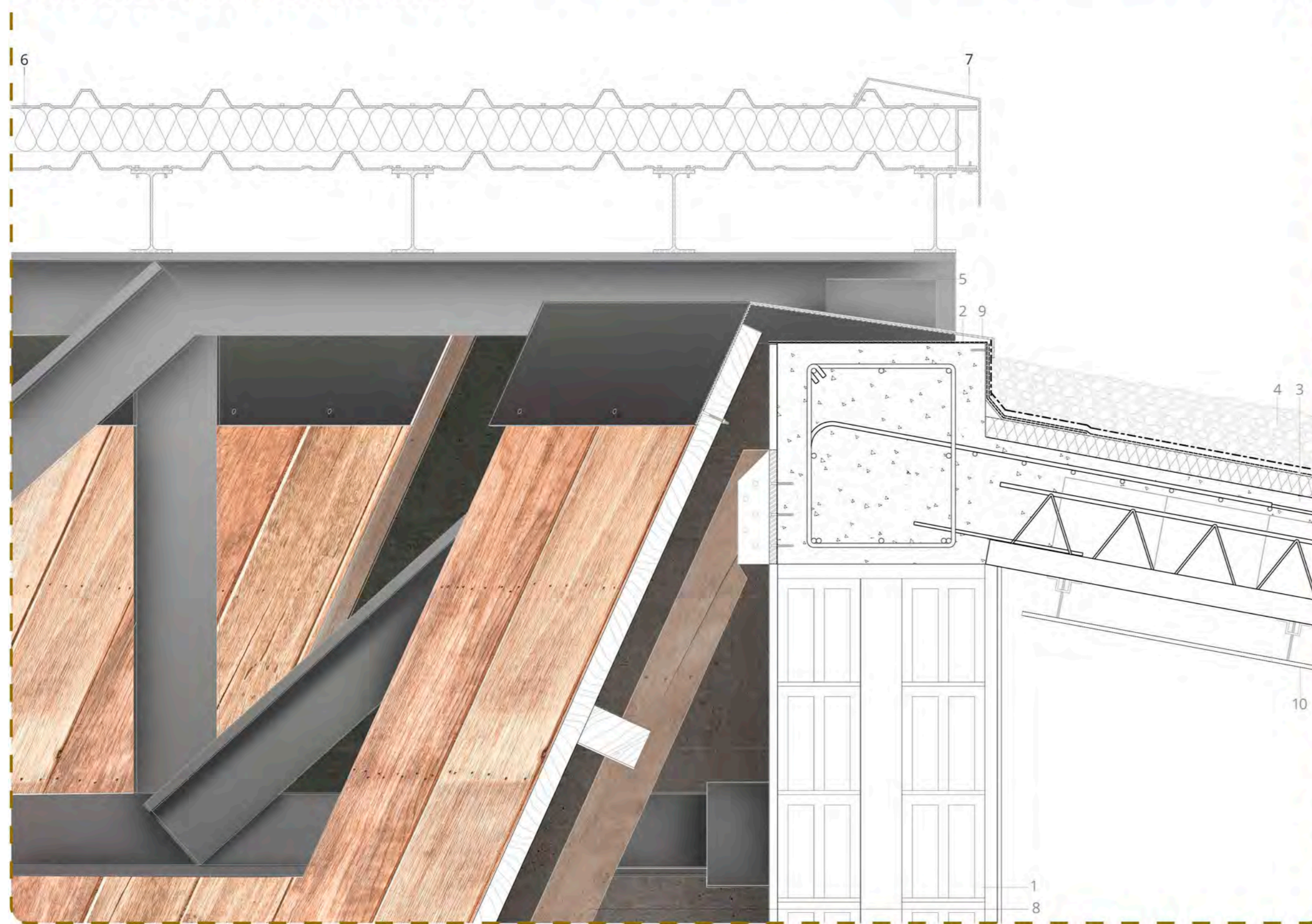
DETALLE 1: ENCUENTRO DE LAS CUBIERTAS
