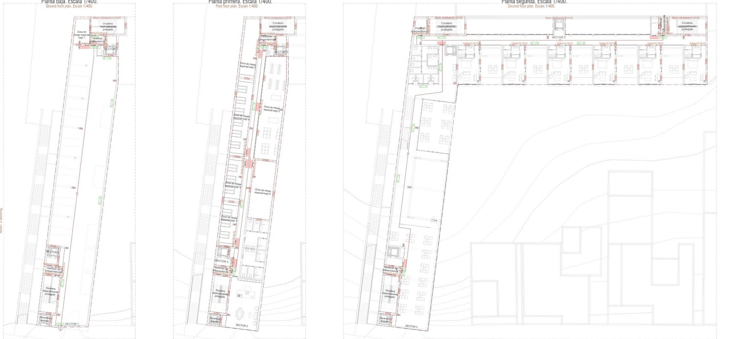
Edificio de uso pública conciencia con 3409 m<sup>2</sup>c y una ocupación total de 351 personas. El edificio se divide en tres sectores, el sector uno (511 m<sup>2</sup>c) que ocuparía la planta baja, con un uso de garaje, el sector dos (610 m<sup>2</sup>c) en la primera planta, con el uso de planta de servicios del hotel, y el sector 3 (2288 m<sup>2</sup>c) en el resto de plantas, con el uso de piscinas, solárium y habitaciones.
