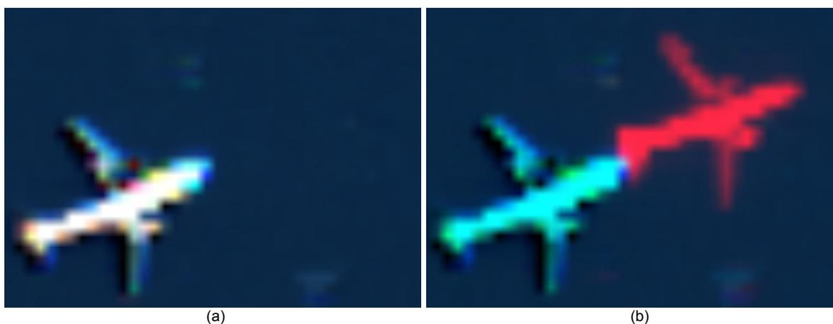
**Figura 26.** Avión sobrevolando el mar en una imagen de Granadilla: (a) falso color construido con las bandas rojo-verde-azul y, (b) falso color construido con las bandas rojo borde-verde-azul.
