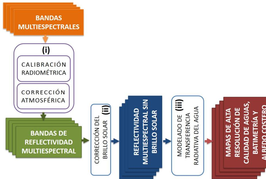
Figura 56. Cadena estándar de procesado con módulos separados.
