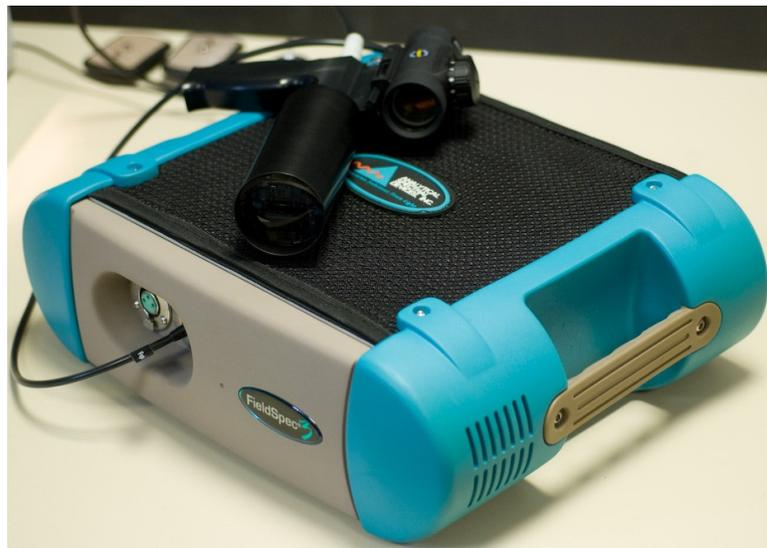
Figura 11. Espectro-radiómetro Vis/NIR ASD FieldSpec 3.
