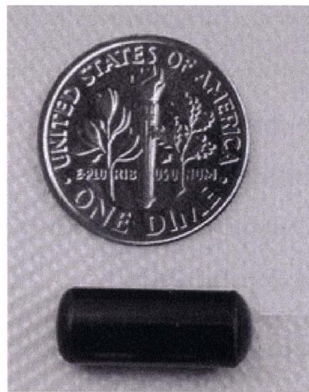
Figura 1.12. Transmisor (TAG) de telemetría acústica usado en la presente Tesis.
