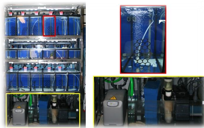
Figura 3.1. Instalación general, detalle de un acuario y del sistema de filtración.
