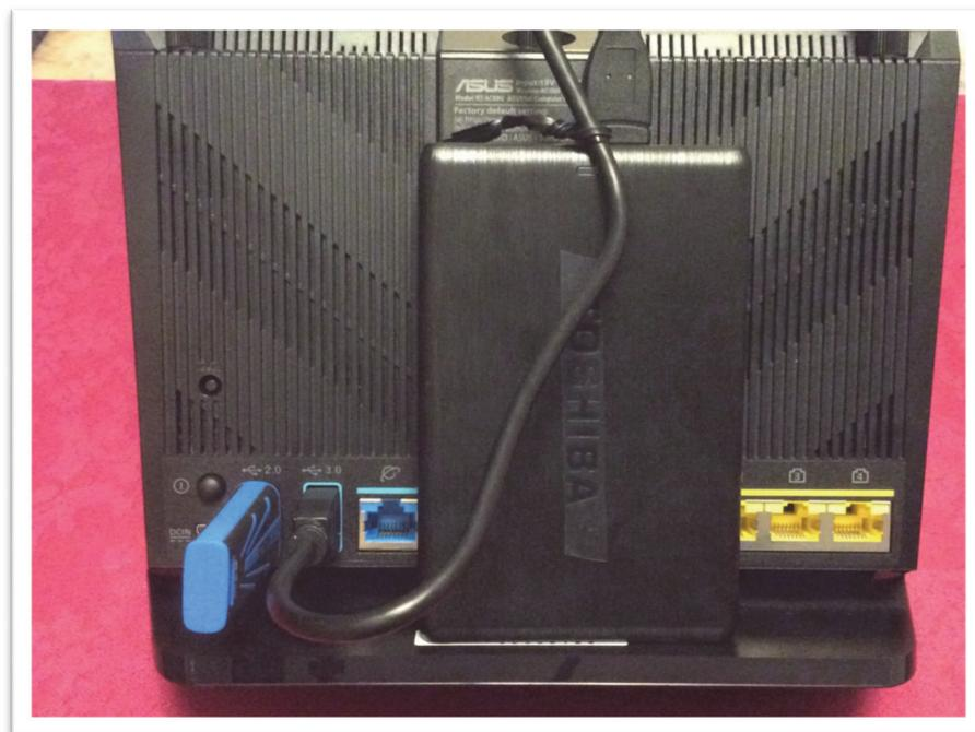
**Figura 86.** Conexión del disco duro al puerto USB 3.0 y Modem 4G al puerto USB 2.0.
