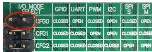
Figura 54. Colocación jumpers para seleccionar comunicación por UART
