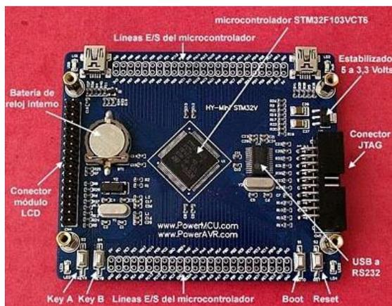
Figura 28. Parte frontal sin pantalla LCD de la placa HY-MiniSTM32V
