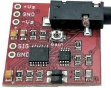
Figura 8. Tarjeta Muscle Sensor v3
