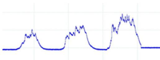
Figura 47. Señal EMG a la salida del Muscle Sensor v3
