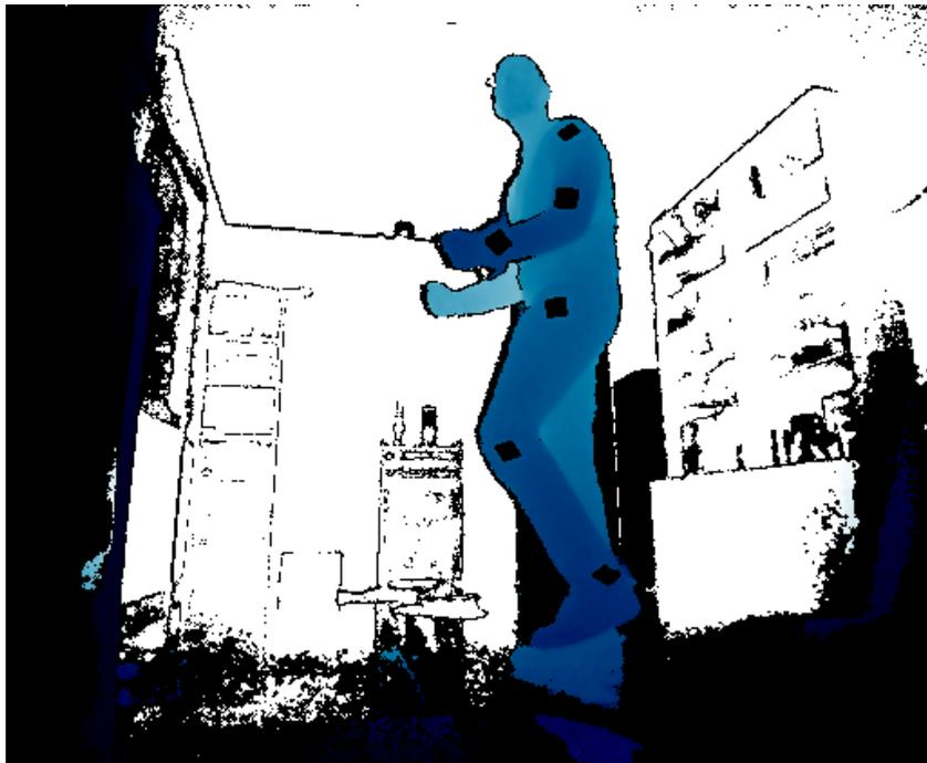
Figura 5.6: Imagen en profundidad con la Kinect v2.
