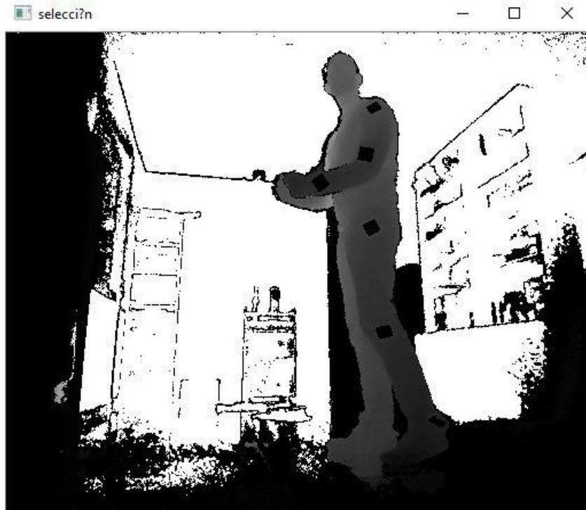
Figura 5.9: Profundidad 2.0, se aprecia que la zona de las marcas da valor 0.
