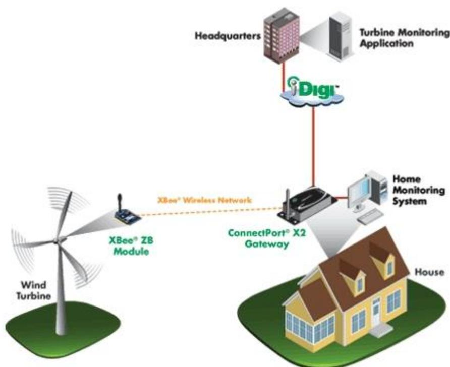
Ilustración 10: Red ZigBee para monitorizar turbinas de viento residenciales
