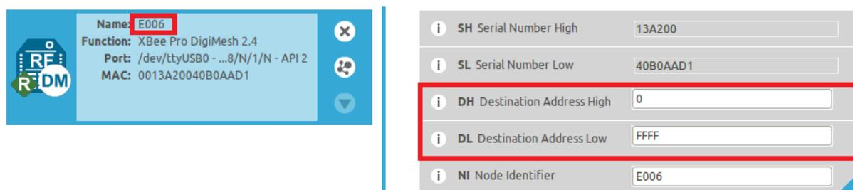
Ilustración 77: Configuración inicial de las radios XBee
