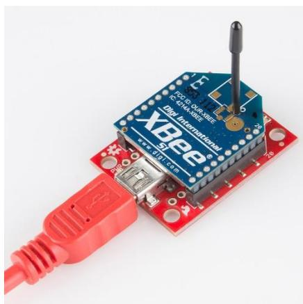
Ilustración 111: Radio conectada a un explorer XBee
