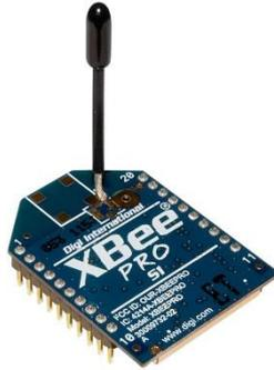
Ilustración 51: Módulo Bee Pro utilizado
