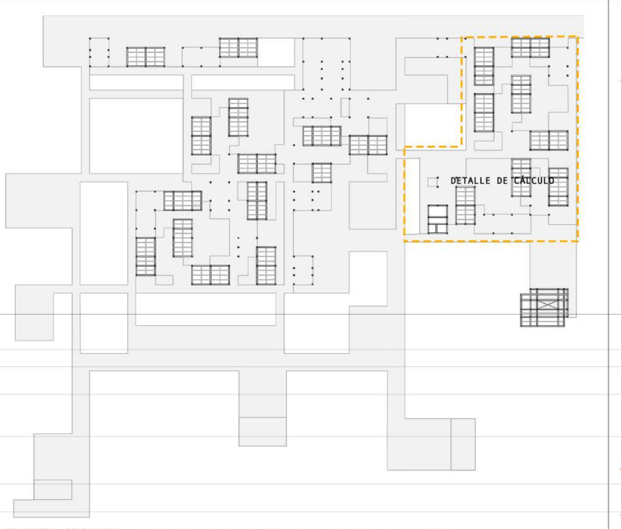
PLANTA SEGUNDA. ENTRAMADO DE VIGAS, CORREAS Y PILARES DE ALUMINIO
