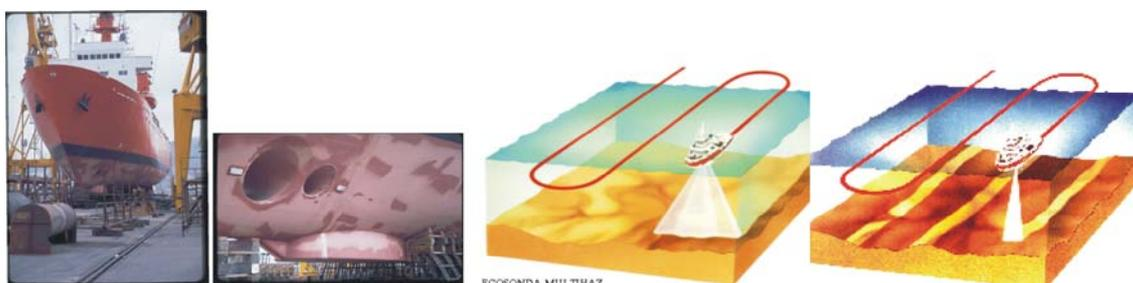
Figura 3: Transductores de los ecosondas multihaz instalados en el BIO Hespérides. Arriba derecha = Esquema de funcionamiento de los Ecosondas multihaz frente a los Ecosondas Monohaz clásicos, con indicación de la zona cubierta sobre el fondo por ambos tipos de ecosondas.
