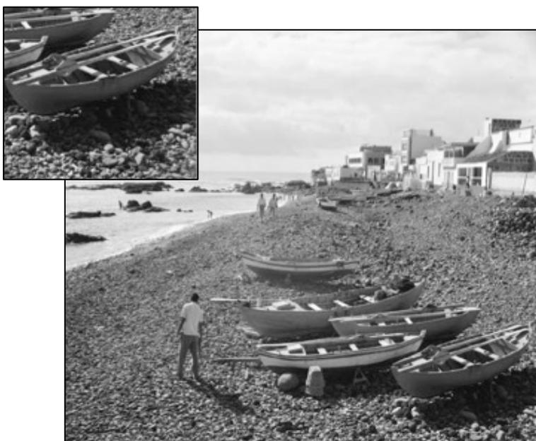
**Foto 2.3.** Barcos de vela/remo en el Puerto de Las Nieves en la década de 1960. En el recuadro superior izquierda, detalle del asiento del palo de la vela. Foto: Hernandez Gil, J.
