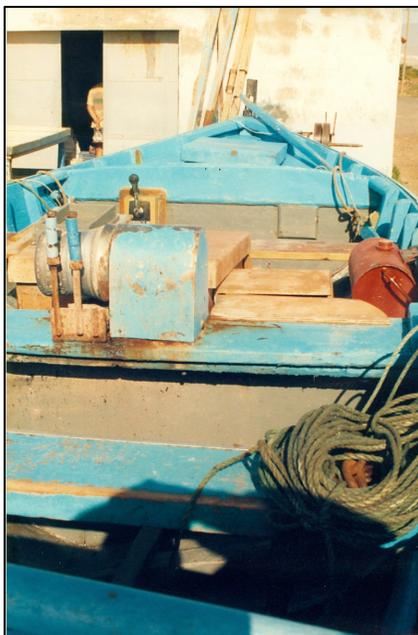
**Foto 2.1.** Detalle de la maquinilla para llevar nasas, montada junto al motor, sobre el asiento de un viejo barco de dos proas.
