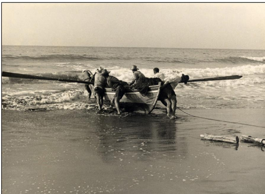
**Foto 2.4.** Los “varales”, pequeña pieza de madera engrasada en su parte central y que era utilizada para arrastrar los barquillos por la playa en las maniobras de botadura y varado. Autor: N. Sánchez Montero. FEDAC.
