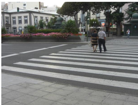
Imagen 32 y 33: Ejemplo de vados peatonales de un mismo del paso de peatón que atraviesa la Carretera del Norte. Carece de pavimento indicador táctil y contrastado color.
