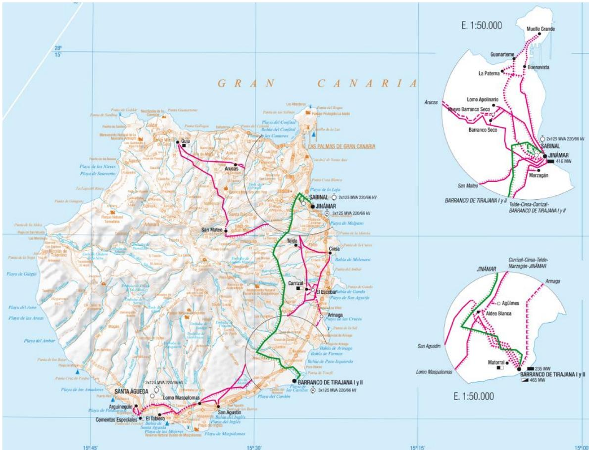
Figura 4.3. Centrales de generación, red y subestaciones de transporte del SEP de Gran Canaria.
