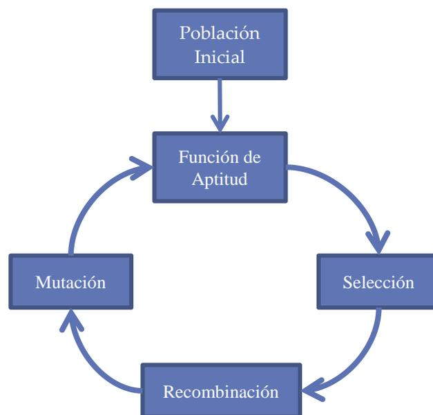
Figura 6.9. Esquema genérico de un Algoritmo Genético
