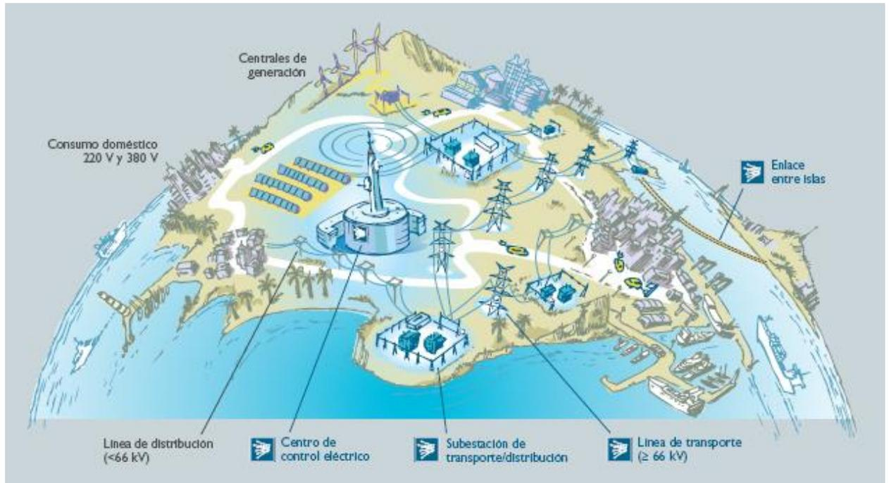
Figura 4.2. Esquema de un sistema de potencia insular.
