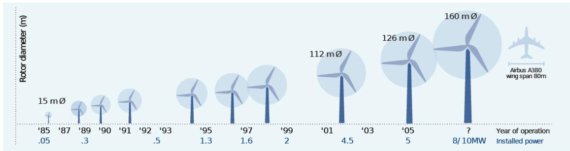
Figura 1.8: Evolución del tamaño de aerogeneradores
