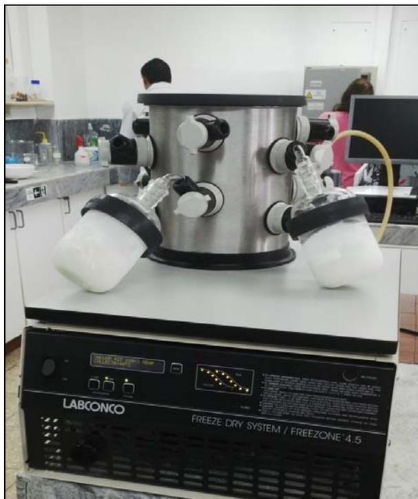
*Fotografía: Equipo liofilizador empleado*
