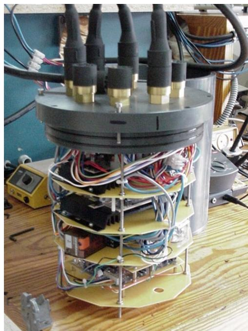
Figura 1. Montaje de la unidad de control y estabilización de la unidad de alimentación.
