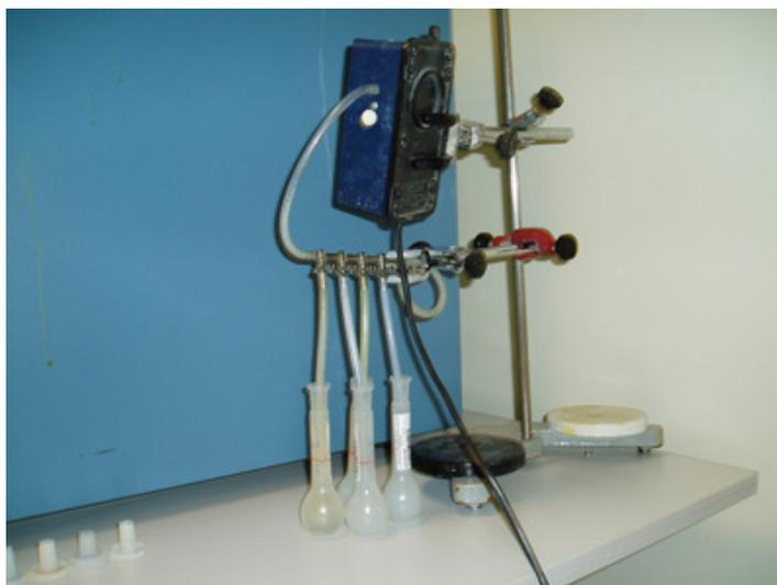
**Ilustración 19.** Purgado de muestras para calcular el NPOC
