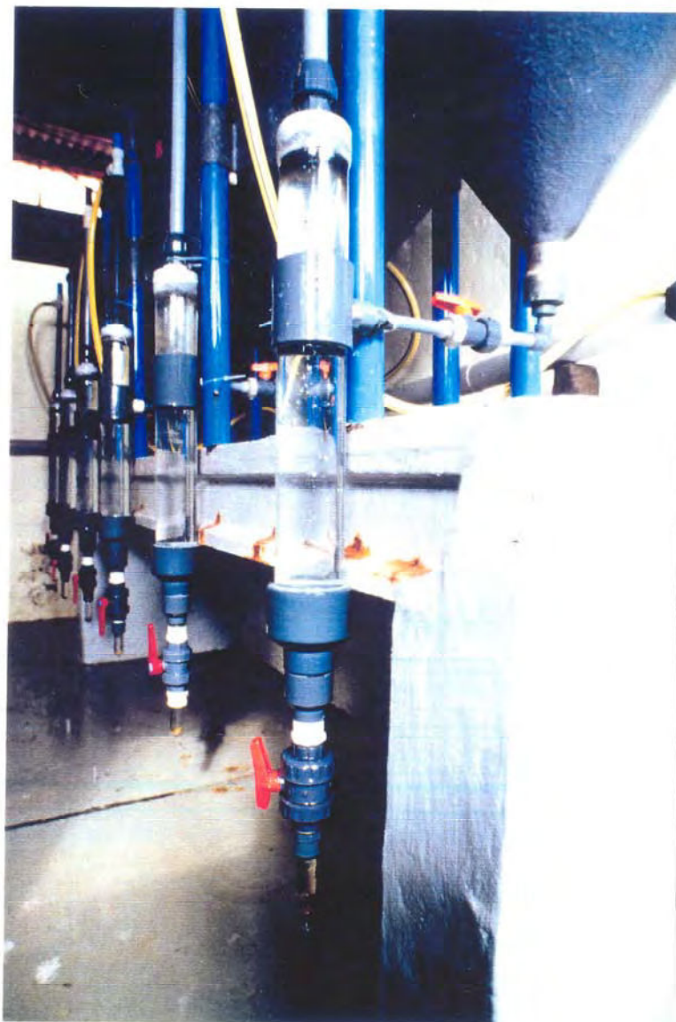
Fig. 5. Detalle del sistema de tanques utilizados en todos los experimentos de digestibilidad.
