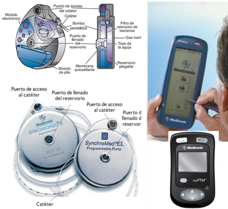
Figura 7.- Características de las bombas SynchroMed EL® y SynchroMed II de Medtronic, con posibilidad de programación telemétrica mediante programador externo, añadiéndose en la actualidad myPTM, un gestor personalizado de dosificación para el uso del paciente.
