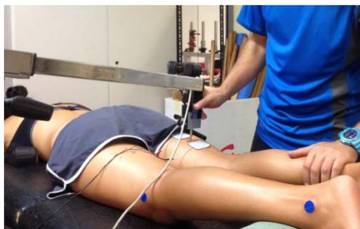
**Figura 14.** Ejemplo de colocación del sensor y los electrodos para la evaluación del bíceps femoral derecho.
