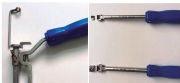
Figura 16 Elementos posicionadores de sistema SLE
