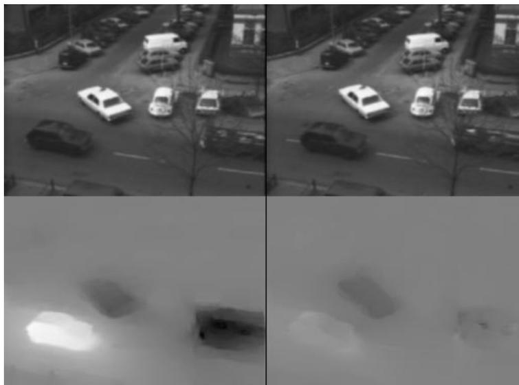
Figura 6.5: Cálculo del flujo óptico para la secuencia del taxi (frames 15 y 19) con  $\alpha = 0.6$ ,  $s = 0.1$ ,  $\sigma_0 = 10$ ,  $\sigma_n = 0.8$ , y  $\eta = 0.95$ .
