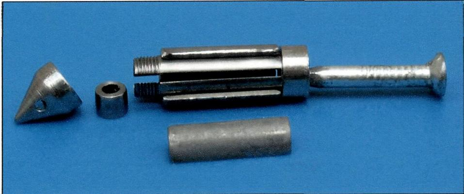
**Fig 5.15** Nuevo mecanismo utilizado para la fijación del LCA. Despiece
