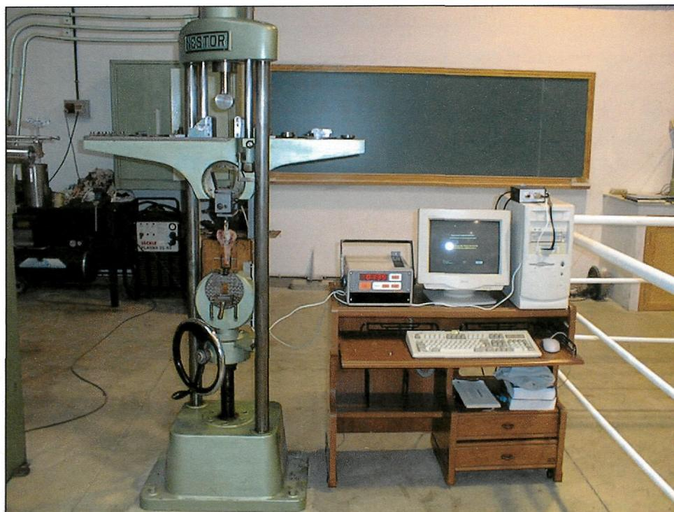
**Fig 5.6** Disposición general de la Máquina de Ensayos
