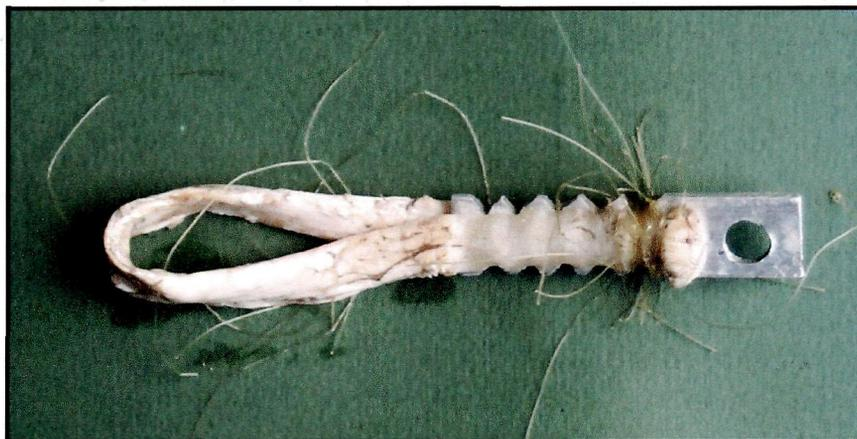
Fig 6.1 Aspecto del tendón, terminado el ensayo
