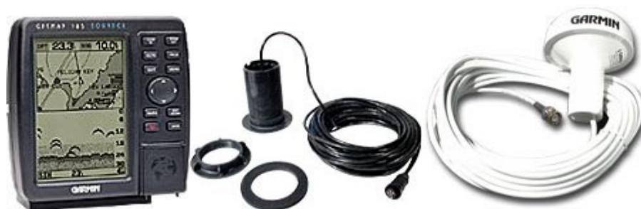
Fig. 3.5: GPSMAP 185 Sounder (Garmin) usado para tomar los puntos batimétricos (izquierda). Se trata de un aparato de uso doméstico que incorpora una ecosonda con transductor de 200 KHz (centro) a un receptor GPS de 12 canales con resolución de 1 m y antena externa (derecha)
