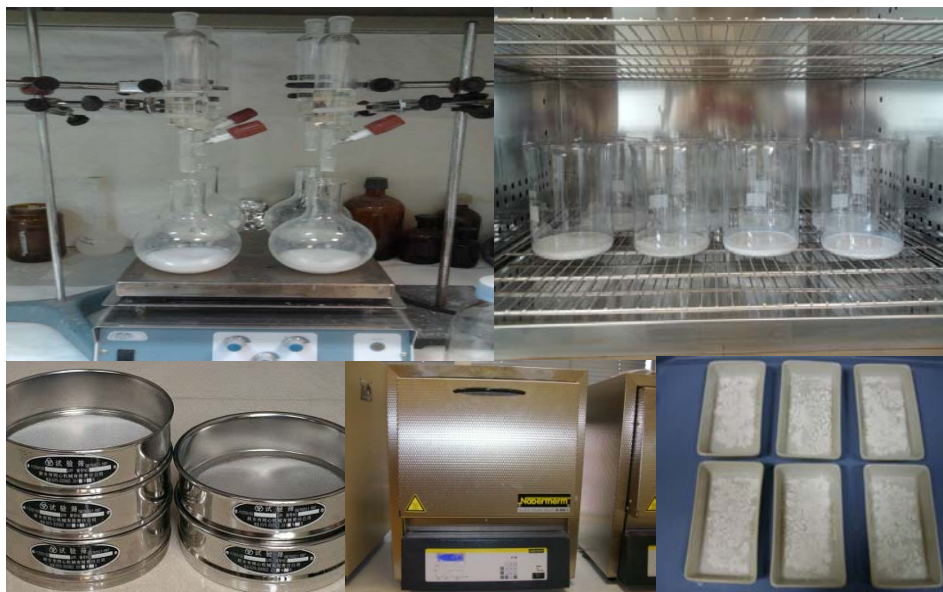
Ilustración 4.1. Etapas de la preparación de los fotocatalizadores calcinados ECT. a) Sol-gel, b) secado en estufa a 105^\circ\text{C} , c) tamizado con tamiz de apertura de malla 63 \mu\text{m} , d) tratamiento térmico en mufla e) material calcinado.
