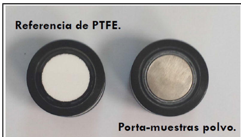
Figura 2.5. a) Esfera integradora y b) material de referencia de PTFE y porta-muestras utilizado para las medidas de DRS
