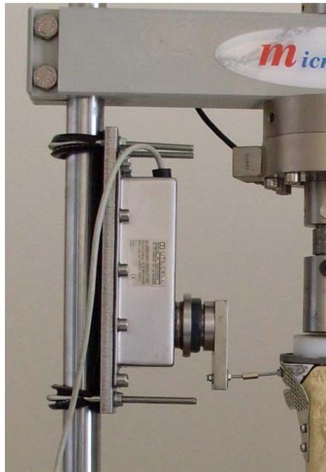
**Figura 5.43 Montaje y orientación de la célula de carga externa**
