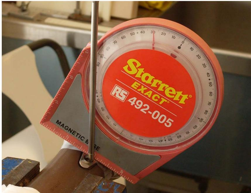
Figura 5.10 Orientación de los taladros de la base de la RK-Plate
