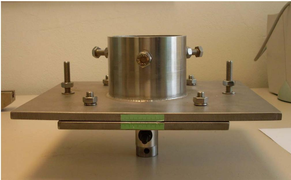
**Figura 5.18 Mordaza para ensayo de tibia**
