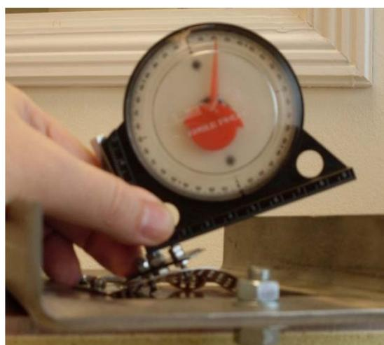
Figura 5.42 Inclinómetro. Medición de ángulo en el bloque
