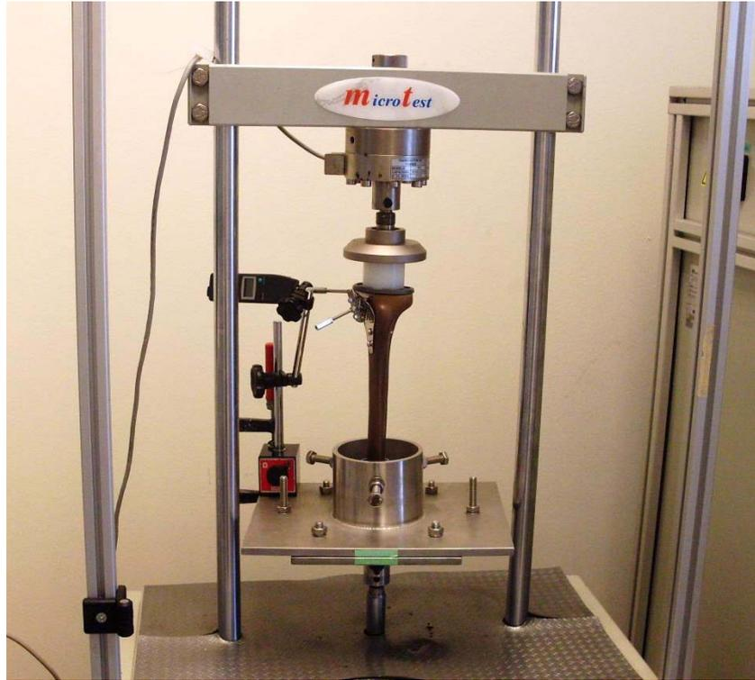
Figura 5.30 Montaje RK-Plate con indicador MDA para medida en B14
