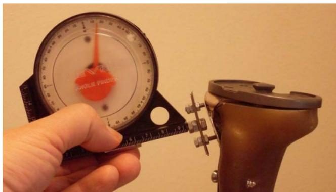
Figura 5.41 Inclinómetro. Medición de ángulo en tibia
