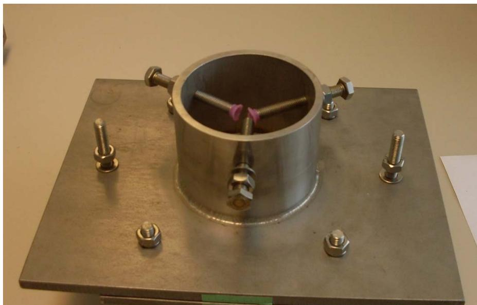
**Figura 5.20 Cazoleta con los tornillos de fijación**
